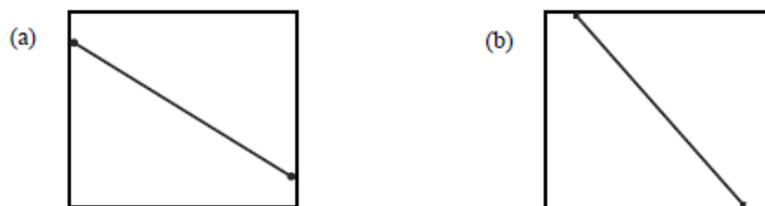
Figure 1.39. Configuration de la bielle proposée dans l'ASCE-41 pour calculer (a) la force dans les poteaux (b) la force dans les poutres. [101]
