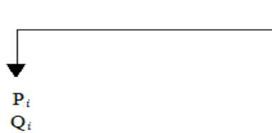
Figure (III-3). Modèle simplifié d'une charge électrique
