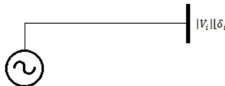
Figure (III-2). Modèle simplifié du générateur.
