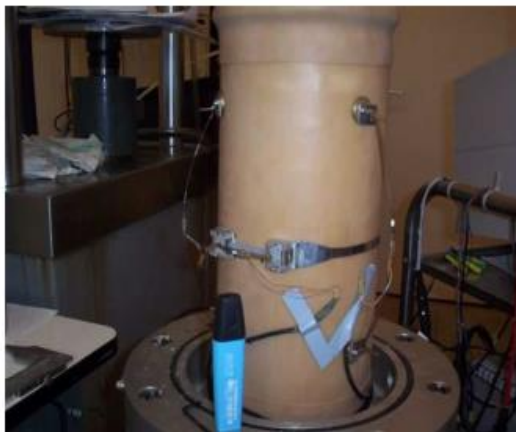
Figure 2-3 Essai triaxial de précision (MSSMat-ECP).
