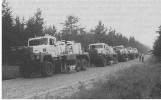
Figure 2-21 Convoi de six camions équipés par des vibrosismiques [38].
