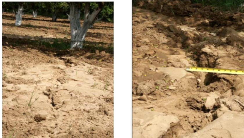
Figure 2-20 : (a) Ébullitions de sable dues à la liquéfaction près de la rivière d'Isser ; (b) Fissuration du sol aux bords de la rivière d'Isser.
