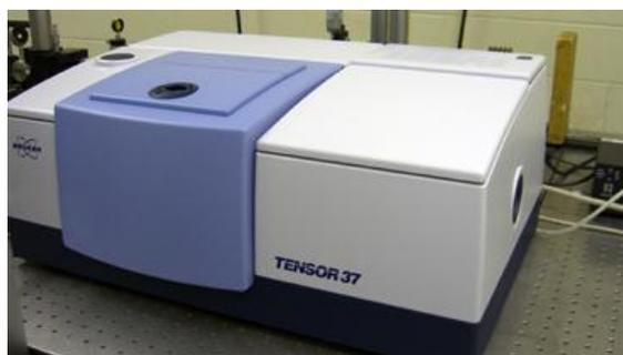
Figure II-4: spectromètre IR BRUKER TENSOR 37
