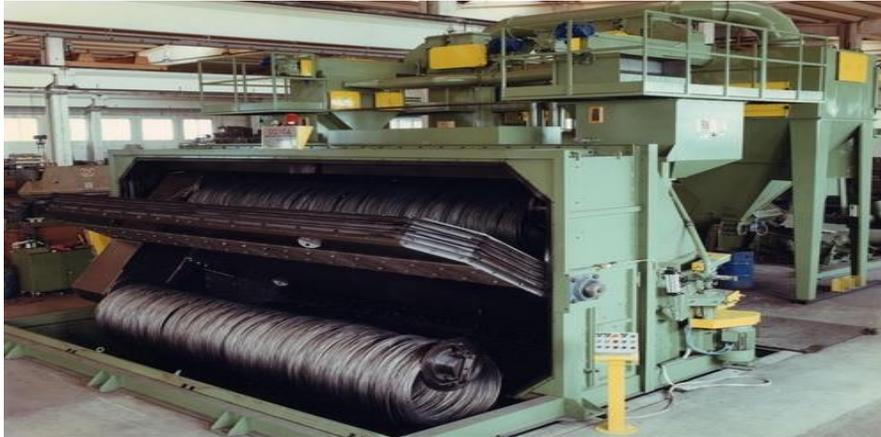
Figure II.4 : Décapage de fil machine
