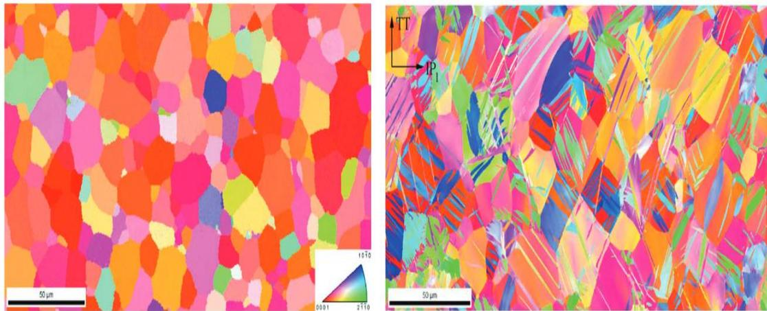
**Figure I.15 :** Apparition de macles lors de la déformation par compression du zirconium [Mackain, 2017] : a) non déformé b) déformé a 14%
