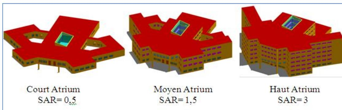
Figure V.14: Les trois cas des configurations modélisés par Tas, testés pour le premier scénario
