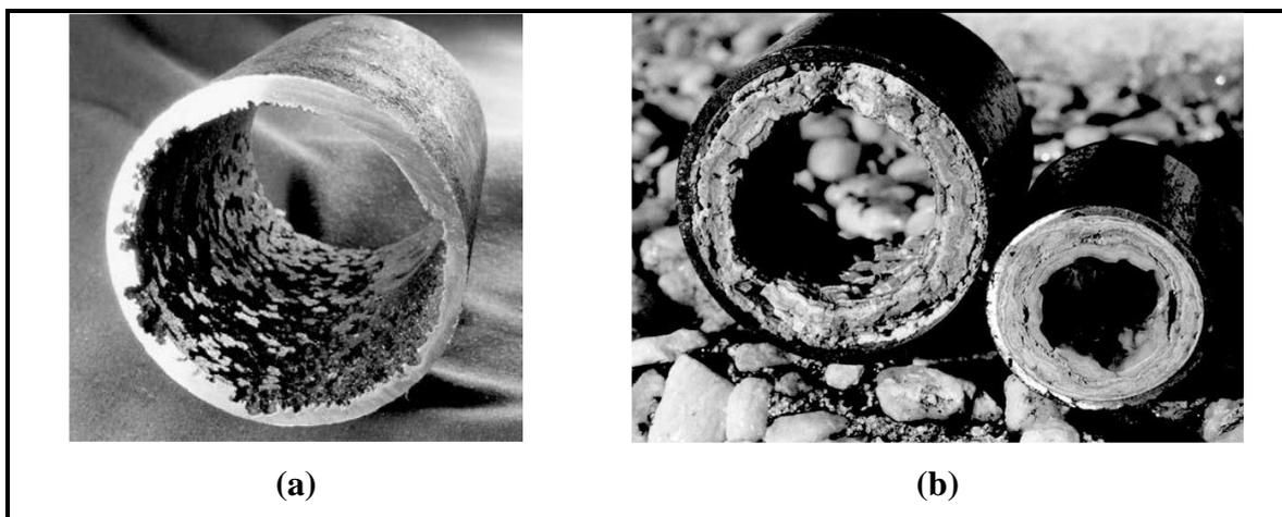
Figure I-1 : (a) une pipe en acier au carbone attaquée par un acide minéral fort, (b) Phénomène de précipitation « scale » d'un tubage de puits [21]
