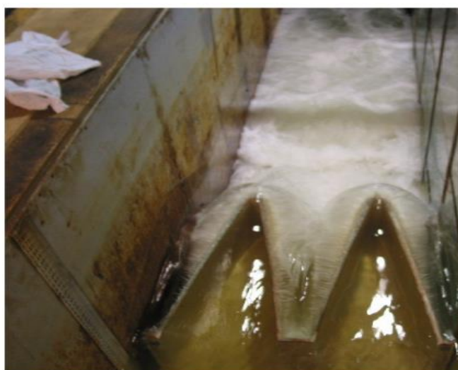
Figure 1.36: Vue plant du labyrinthe à 2 cycles (Savage et al., 2004).
