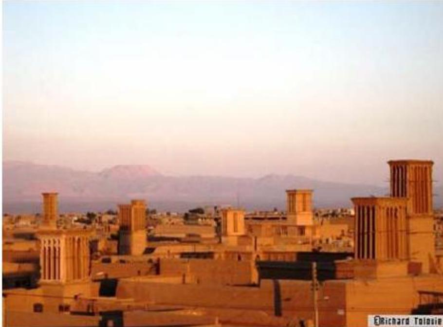
Figure I. 11 : Tour à vent pour refroidisse ment passif dans l’architecture Iranienne.
