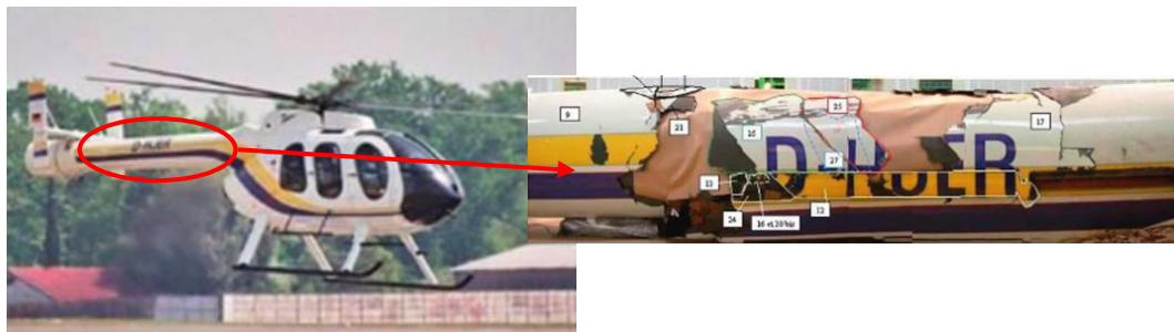
FIGURE 1.12. Dégât de ruine d'une structure composite d'un hélicoptère [35].
