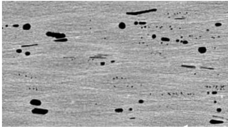
FIGURE 1.15. Image tomodensitométrique sur la présence de la porosité (0.9%) [40].
