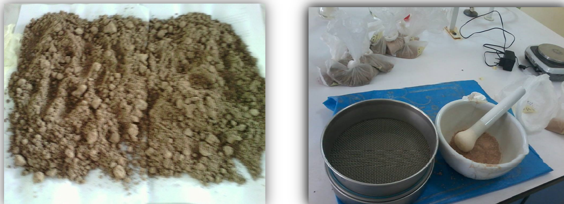
Figure 10 : Séchage, Broyage et Tamisage du sol (2016)
