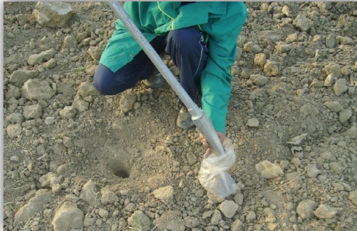
Figure 9 : Méthode duprélèvement du sol par une tarière (2013)
