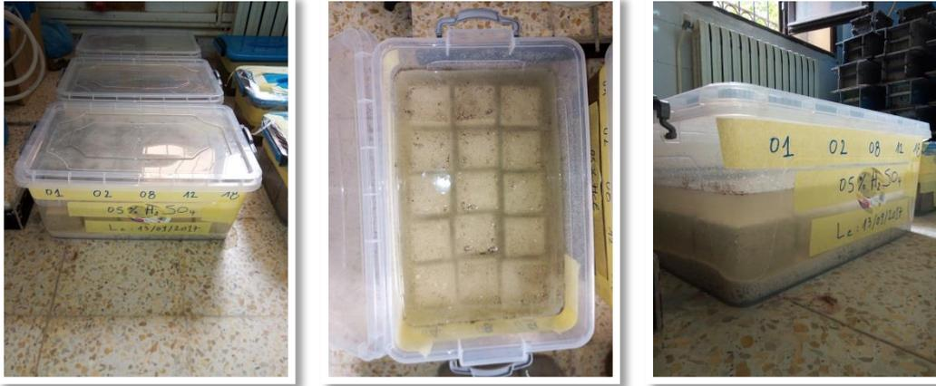
Figure III.14. Conservation des éprouvettes dans les milieux agressifs : 5% HCl et 5% H<sub>2</sub>SO<sub>4</sub>
