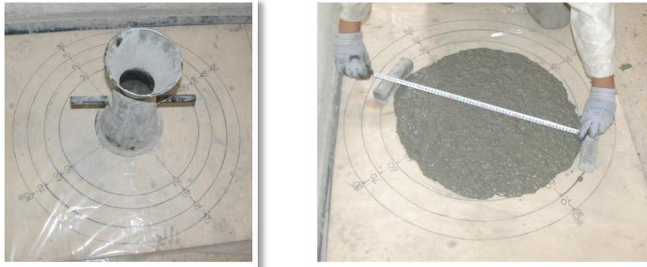
*Figure III.6. Images de l'essai d'étalement : à gauche cône d'Abrams et table d'essai, à droite mesure de l'étalement*
