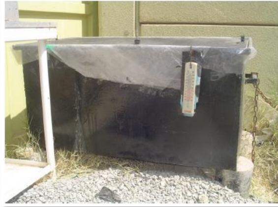
Figure II.51. Chambre de traitement à la vapeur exposée aux rayons solaires utilisée par Benammar et al. [139]
