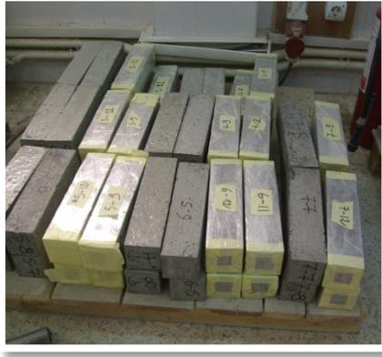
Figure III.10. Image des éprouvettes conservées à l'air
