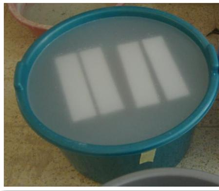
Figure III.9. Image des éprouvettes conservées dans l'eau
