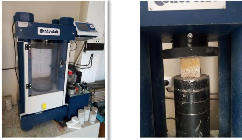
Figure III.11. Machine et dispositif de mesure de la résistance à la compression
