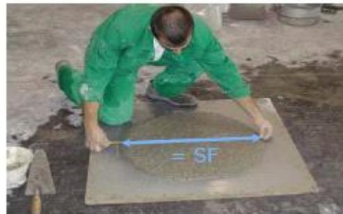
Figure I.8. Essai d'étalement au cône (slump-flow) [117]
