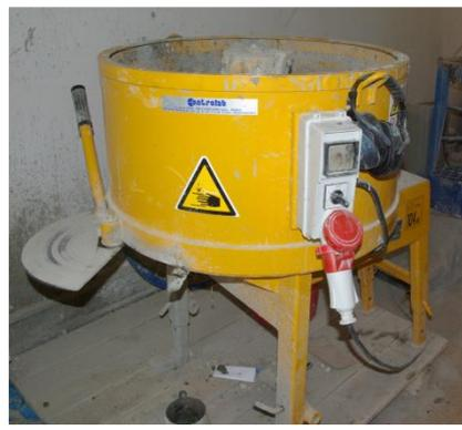
Figure III.5 : Image du malaxeur de béton utilisé
