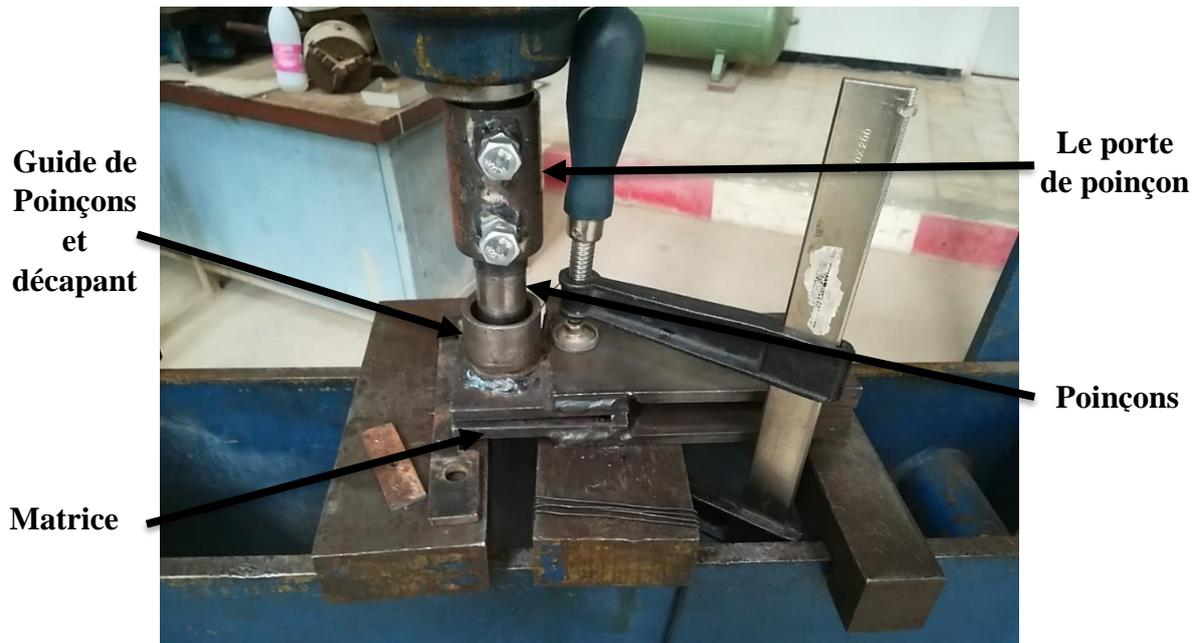
**Figure 4.11** : Outil de coupe de diamètre 28 mm.
