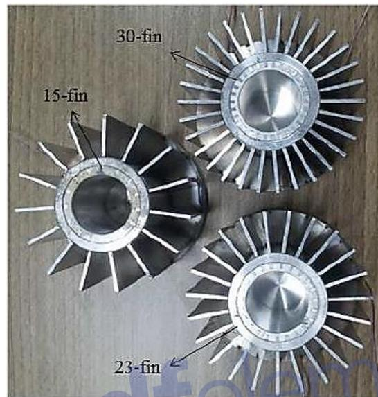
**Figure 1.35 :** Dissipateur de chaleur avec différent nombre des ailettes.
