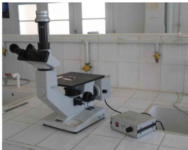
**Figure III.2 :** Microscope optique de type HUND .
