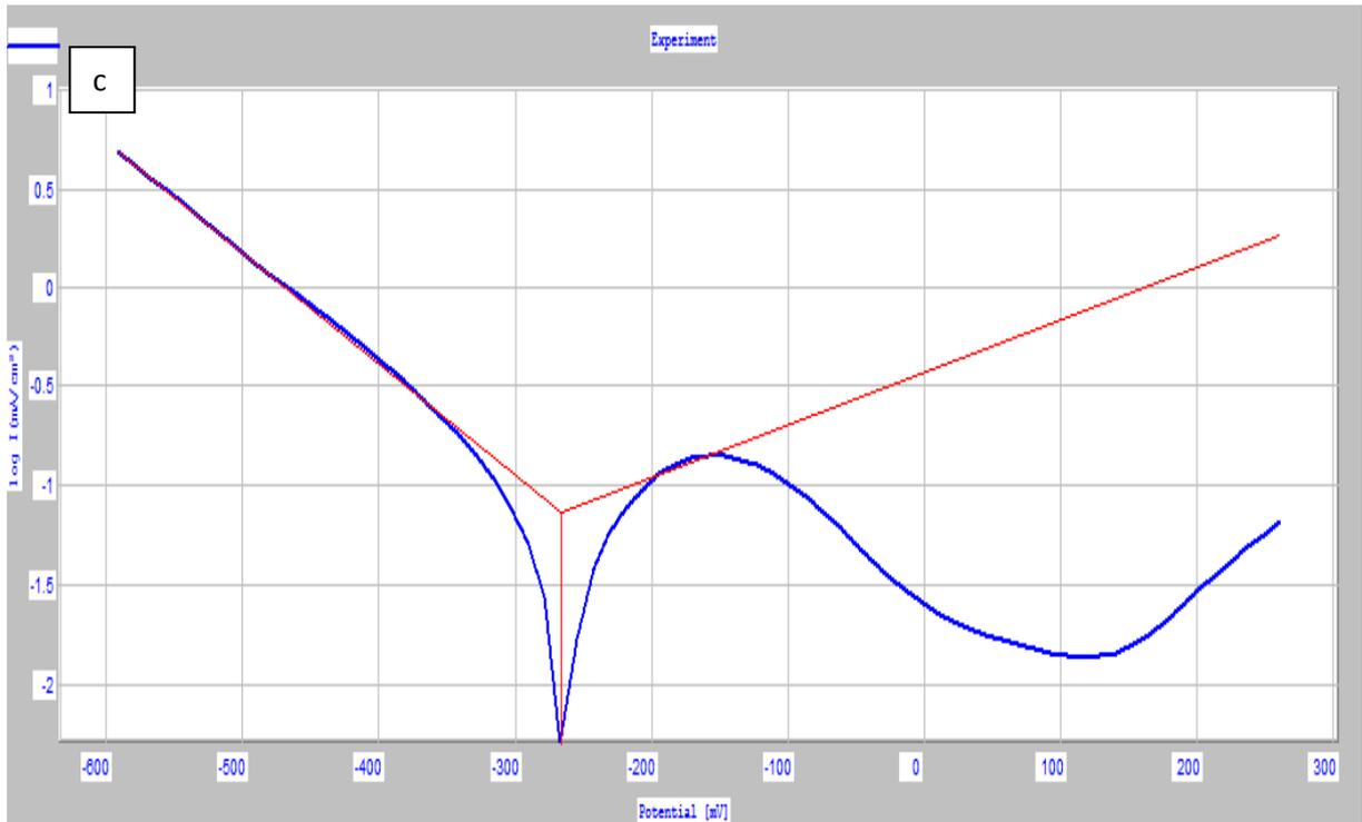
**Figure IV.27:** Courbes de polarisation de l'alliage (Ni-Cr-Mo) à T=980°C : a) :(échelle linéaire), b) :(échelle logarithmique), c) : avec l'extrapolation des droites de Tafel dans S1
