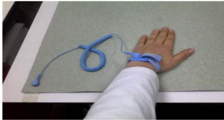
FIGURE 2.13 : Tapis et bracelet antistatiques.
