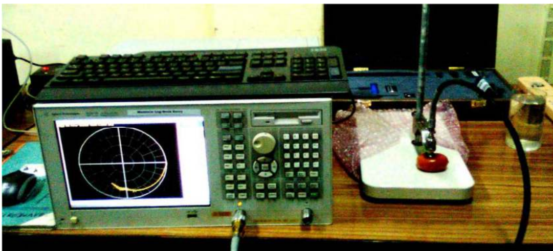
FIGURE 1.15 : Configuration de la mesure constante diélectrique de la tomate avec le kit de sonde diélectrique Agilent 85070E et le VNA. [26]
