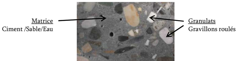
*Figure 2.2: Vue en coupe d'une structure en béton*
