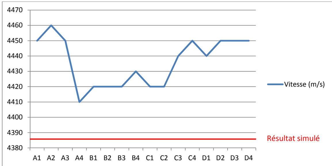
*Figure 4.5.: Résultats expérimentaux sur éprouvette CF\_P3\_B10*
