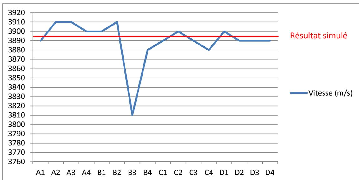
Figure 4.4. : Résultats expérimentaux sur éprouvette CF\_B10
