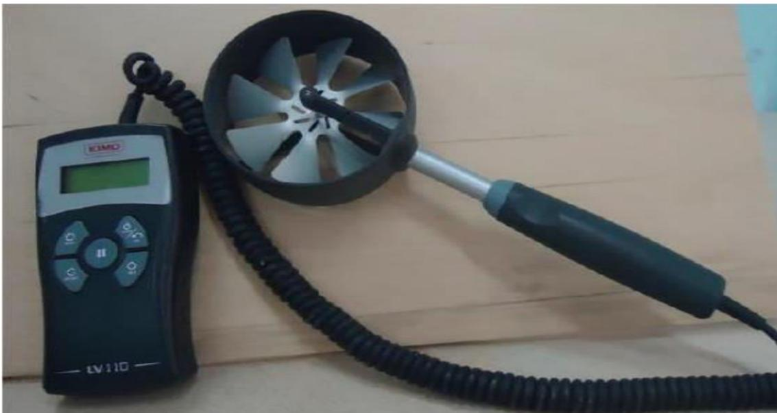
**Figure : III.5** Photo de l'anémomètre à hélice LV100
