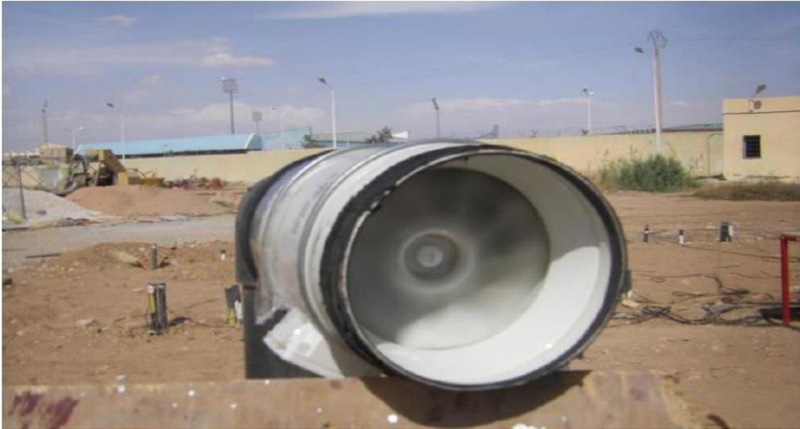
**Figure : III.4** Photo du ventilateur S&P TD-800
