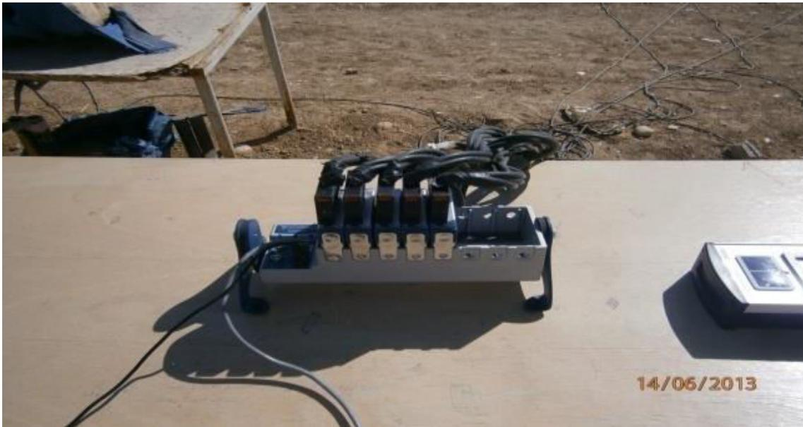
Figure : III.6 Photo de la carte d'acquisition DAQ-9188 de (National Instruments).
