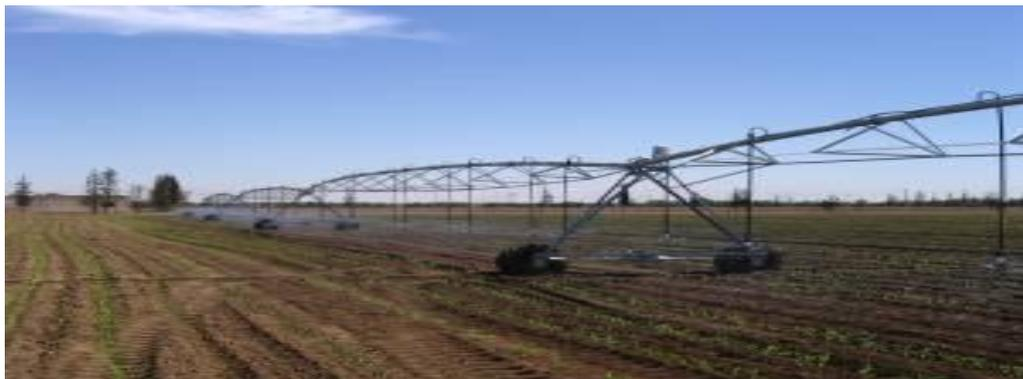
**Figure III.15 : Pivot (rampes pivotante) (photo originale).**
