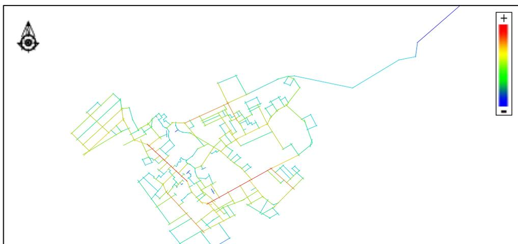
**Fig. VI. 57:** Résultats de l'analyse axiale pour la mesure de l'intégration locale. Source : Auteur
