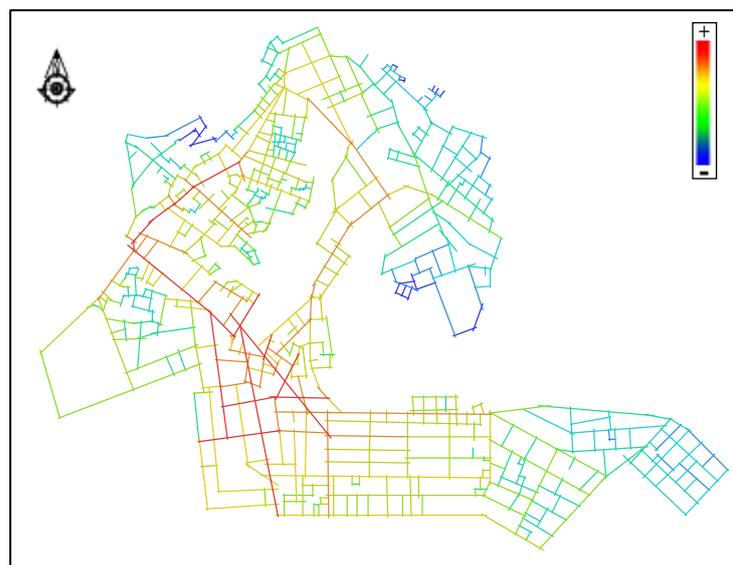
Fig. VI. 36 : Résultats de l'analyse axiale pour la mesure de l'intégration globale.
