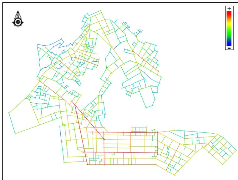
**Fig. VI. 37:** Résultats de l'analyse axiale pour la mesure de l'intégration locale. Source : Auteur
