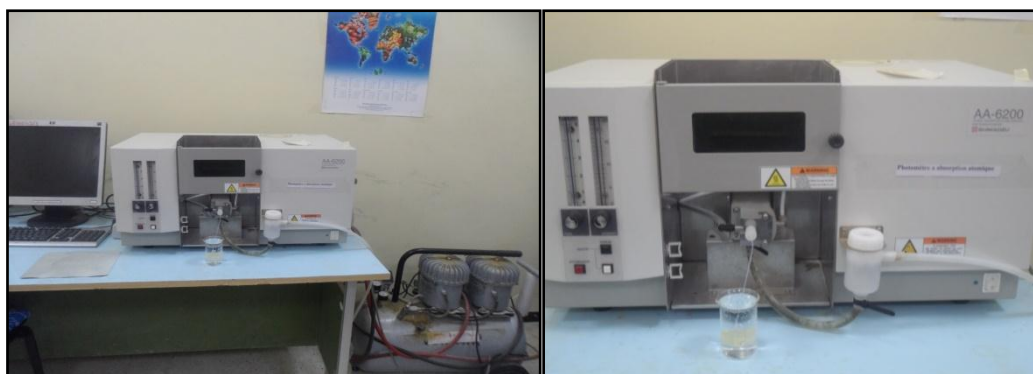
Figure 15: Appareil d'absorption atomique utilisé pour le dosage du cuivre.
