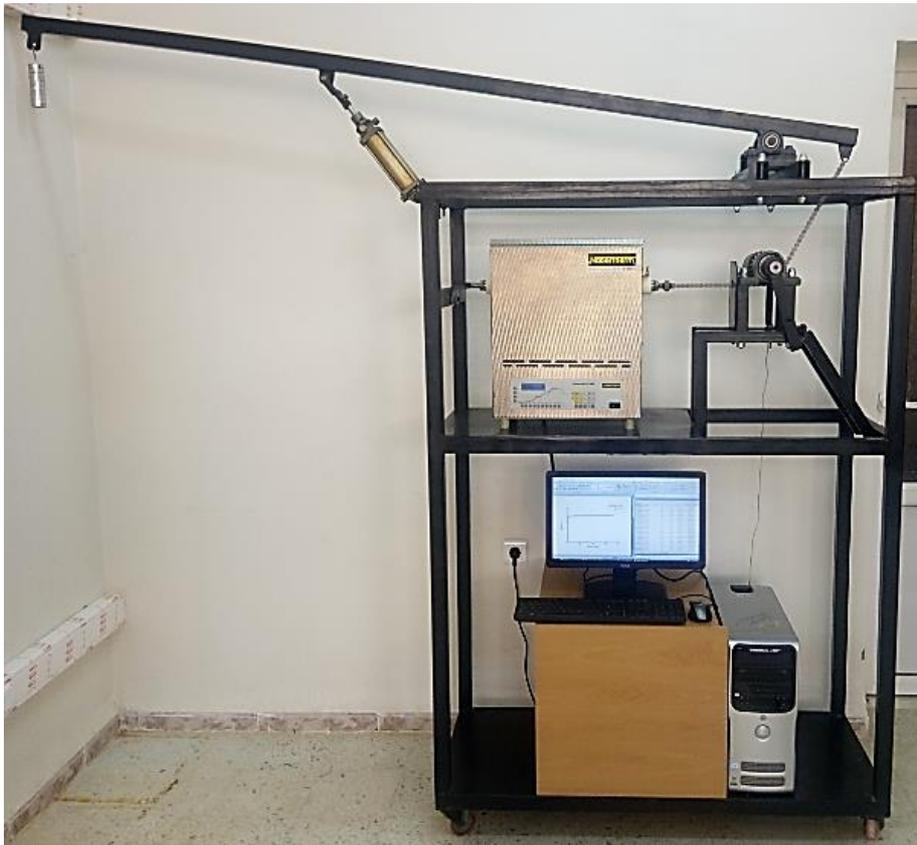
**Figure III-11** : Appareil d'essai de fluage.
