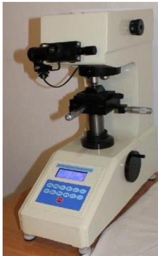
Figure III-9 : Microduromètre de marque HVS-1000Z.
