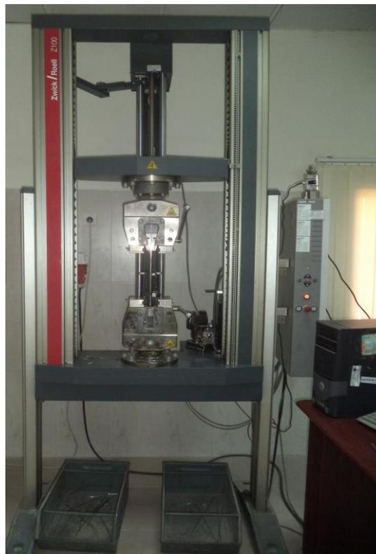
**Figure III-10** : Machine de traction de type Zwick/Roell (Z100) (EN.I.CA.B).
