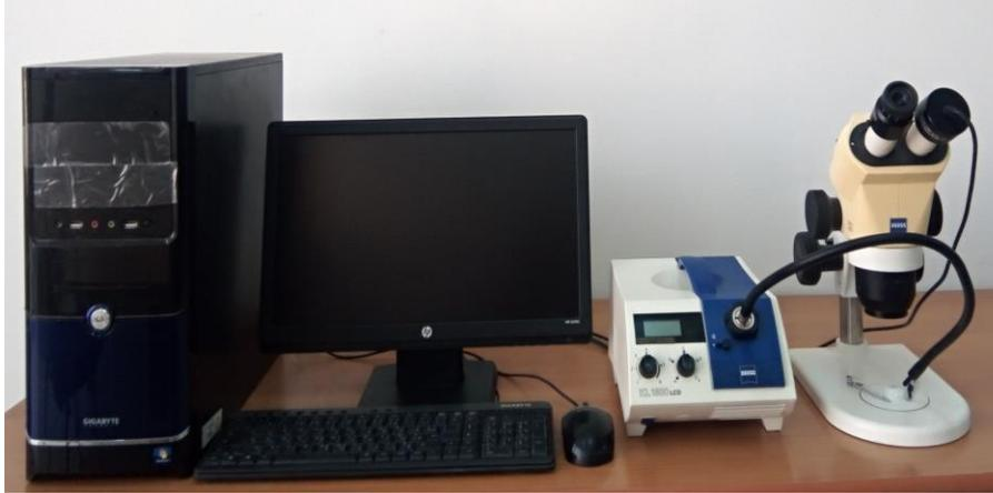
**Figure III-4** : Microscope optique en lumière polarisée de type Stemi 2000.
