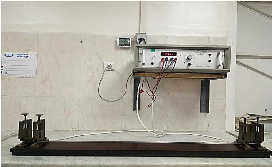
Figure III-8 : Résistomat de type 2302 (EN.I.CA.B).
