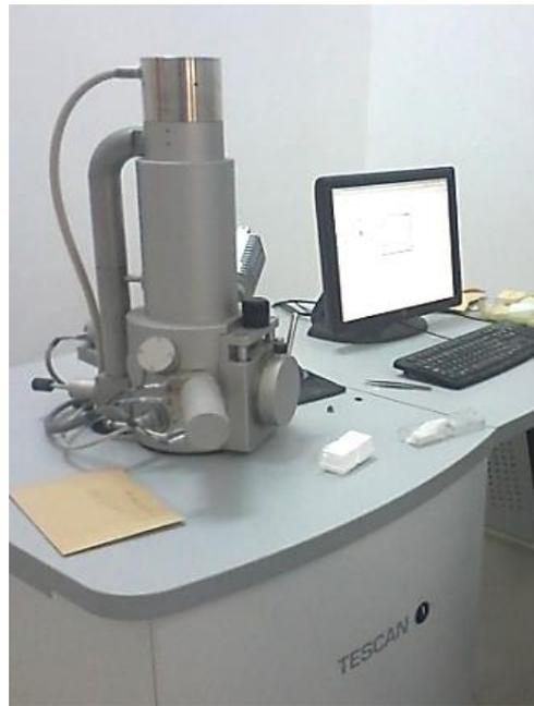
**Figure III-6** : Microscope électronique à balayage de type « TESCAN VEGA Easy Probe ».
