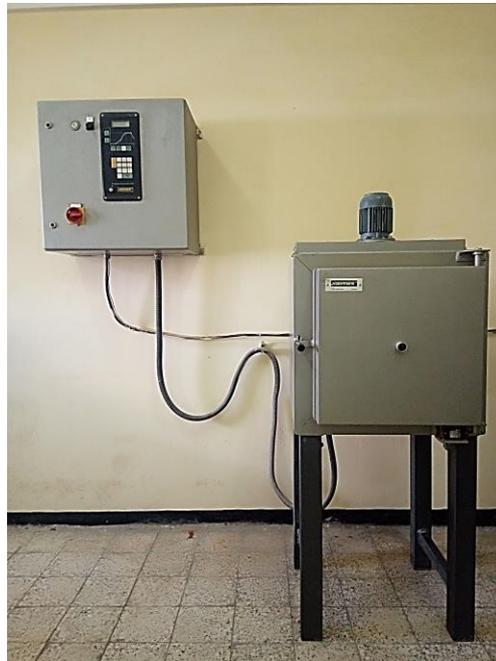
**Figure III-2** : Four pour traitement thermique.
