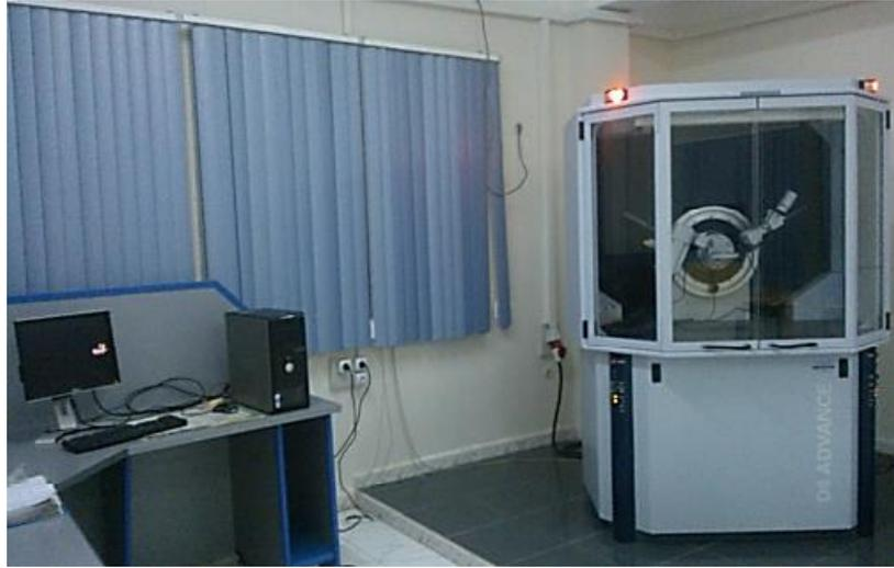
Figure III-7 : Diffractomètre des Rayon X de type BRUKER D8 ADVANCE.
