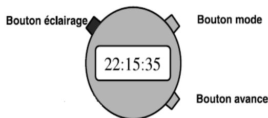
**Figure 4.24: Montre à cadran numérique simplifiée.**
