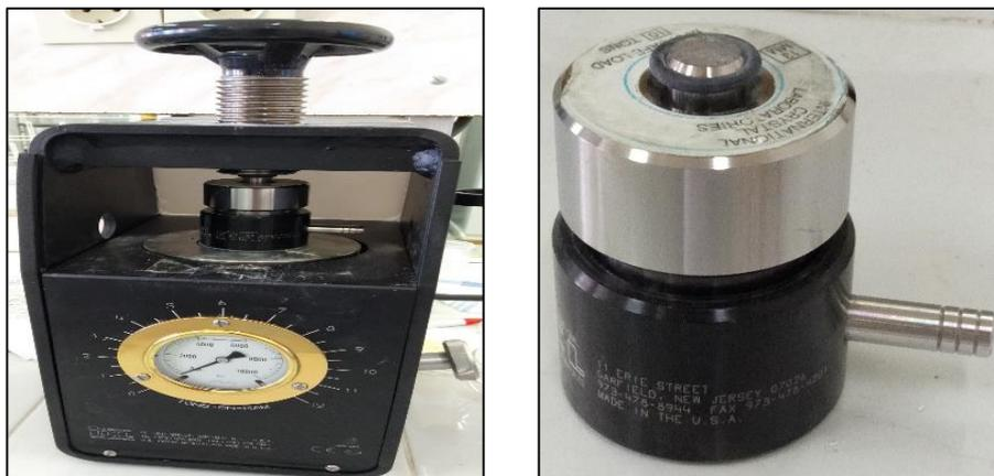
**Figure (II.12)** : La presse et le moule utilisée pour la préparation des pastilles.
