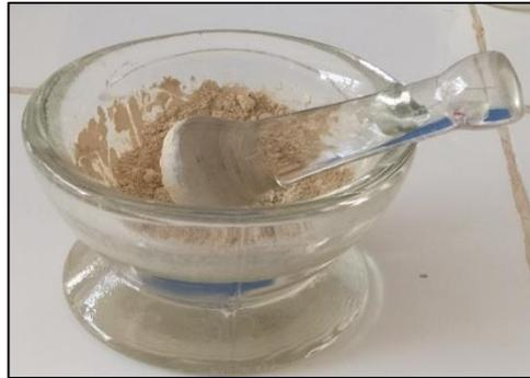
**Figure (II.11)** : Un mortier en verre.
