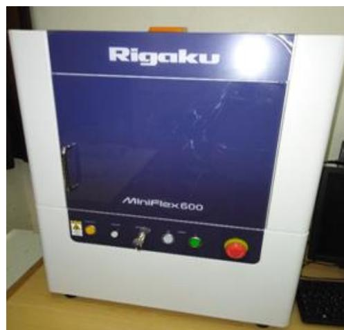
Figure (II.20) : Principe du diffractomètre à poudre et DRX utilisé.
