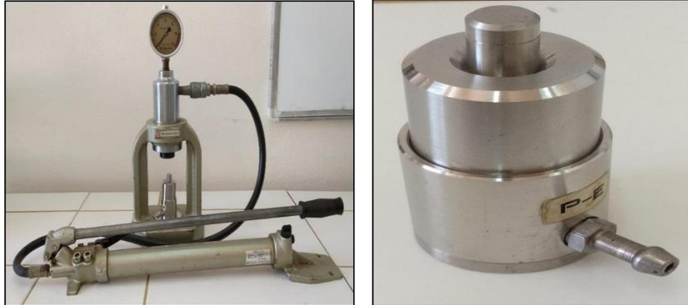
**Figure (II.14) :** La presse et le moule utilisée pour la préparation des pastilles.
