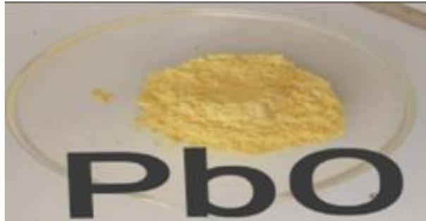
**Figure (II.1)** : La poudre de monoxyde de plomb PbO.
