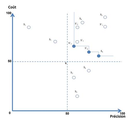
Figure 4.6: Sélection des capteurs Skyline dynamique.
