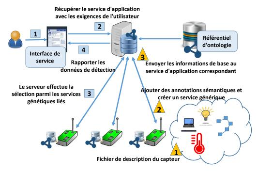
Figure 3.7: L'architecture de service de détection proposée par Hus.
