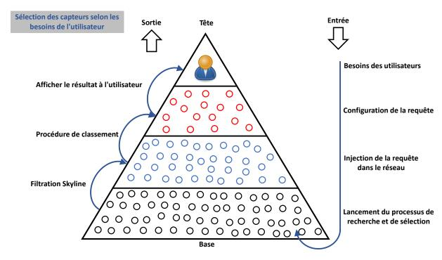
Figure 4.2: Le modèle Tête-Base pour la configuration des requêtes, la recherche et la sélection des meilleurs capteurs.
