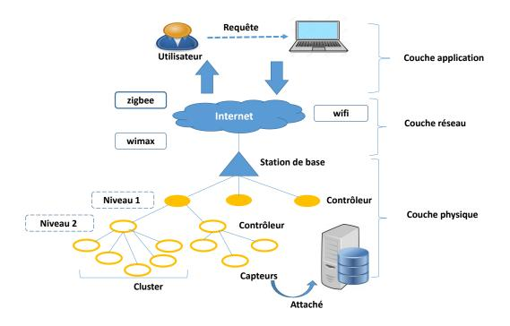
Figure 3.3: Architecture de l'approche de Ramachandran .
