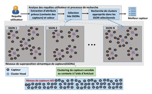
Figure 3.5: Vue d'ensemble du système Antclust.
