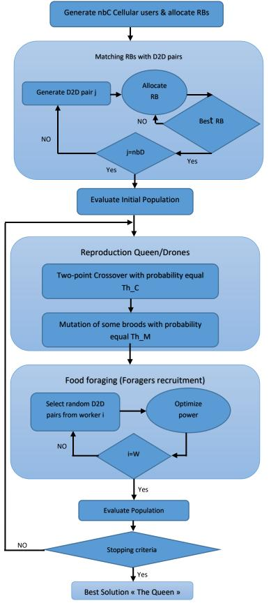
Figure 4.1. Flowchart of the MBA algorithm.
