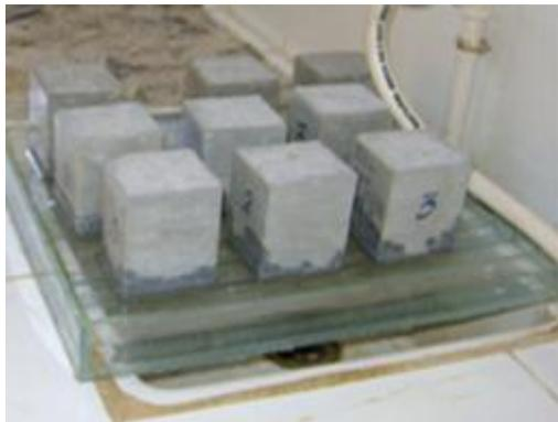
A/ Dispositif expérimental pour l'essai d'absorption capillaire
