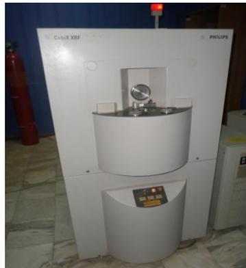
**Photo III.2** : L'appareil de marque Cubix XRF utilisé pour la détermination des taux des oxydes du matériaux, *Laboratoire de-Ain Lekbira (09/2017)* ([Sétif](#))
