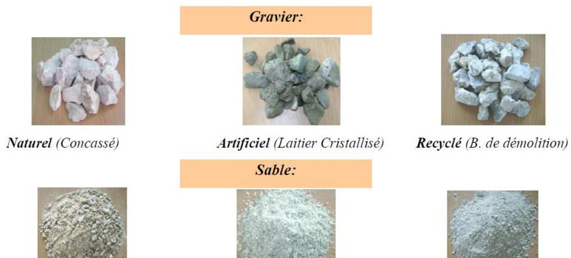
**Figure I.23:** Photos des différents types de granulats
