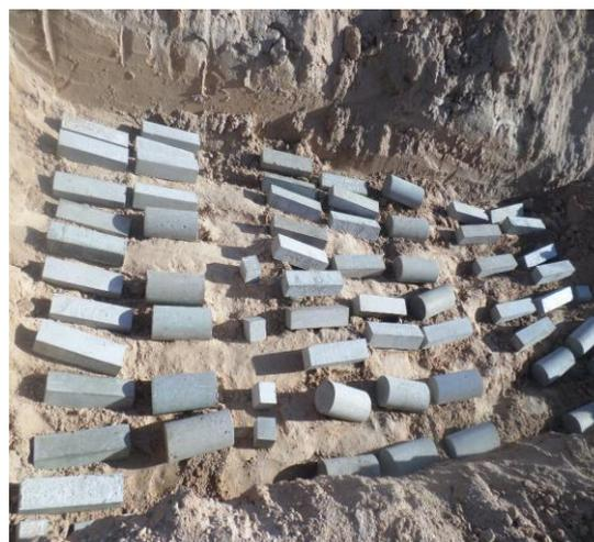
Photo III.4 : Conservation des éprouvettes dans sol agressif
