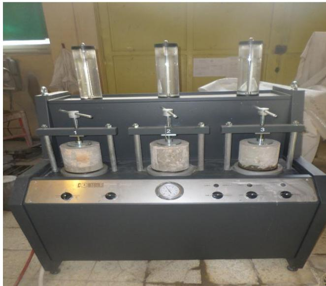
**Photo IV.2 :** Appareillage d'essai de perméabilité
