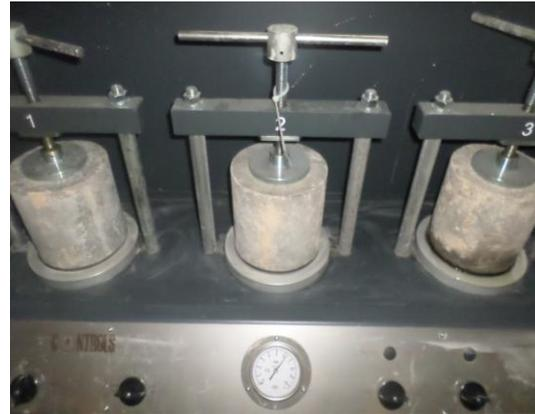
**Photos III.6** : Essai de perméabilité. (Laboratoire de GC de l'Université de Biskra /2018)
