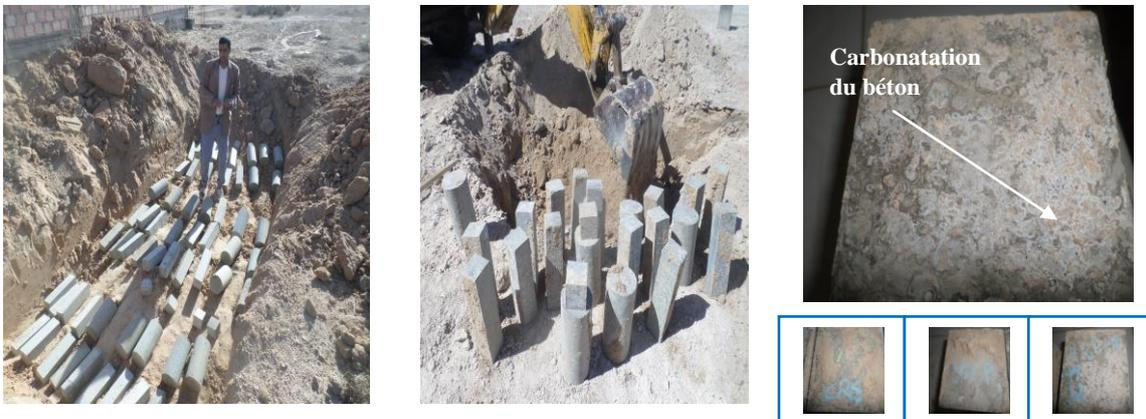
**Photo II.5:** Nous notons la détérioration de la surface des échantillons des bétons placés dans le sol (commune de Lioua)
