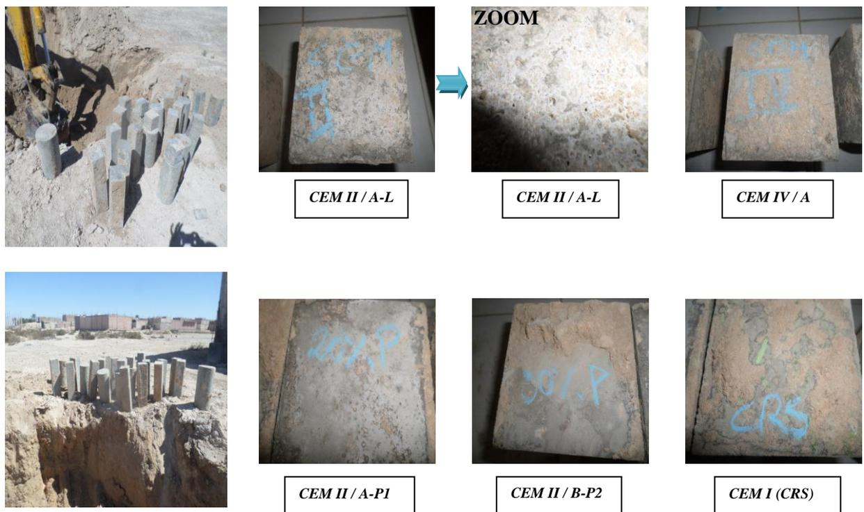
Figure IV.57: Aspect des éprouvettes à la sortie de sol agressif.
