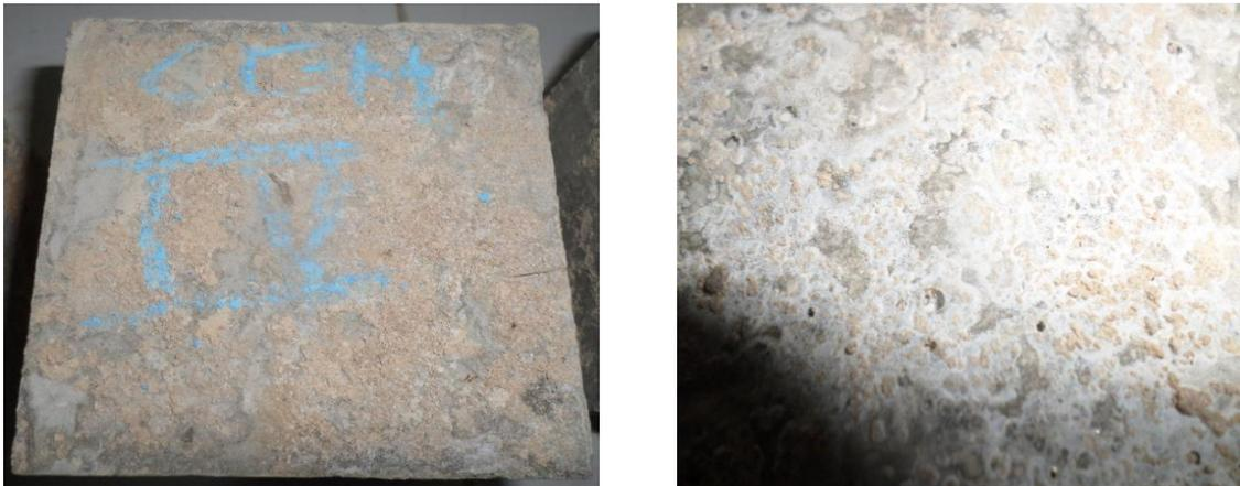
**Photo IV.1** : Détérioration de la surface des échantillons de béton placés dans le sol (commune de Lioua)
