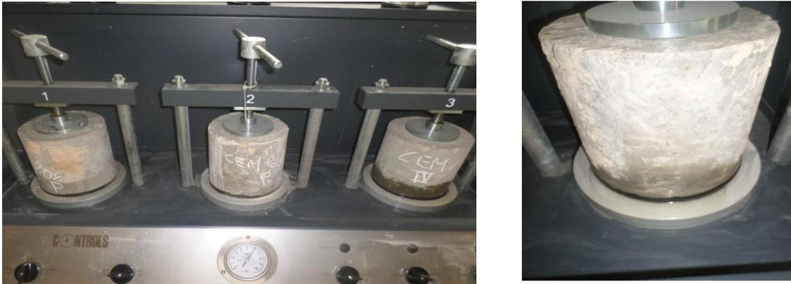
**Photo IV.3:** La perméabilité du béton placé dans le sol (commune de Lioua)
