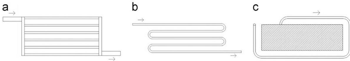
Figure 2.2. Différentes configurations de conduits sous le niveau du sol [54].
