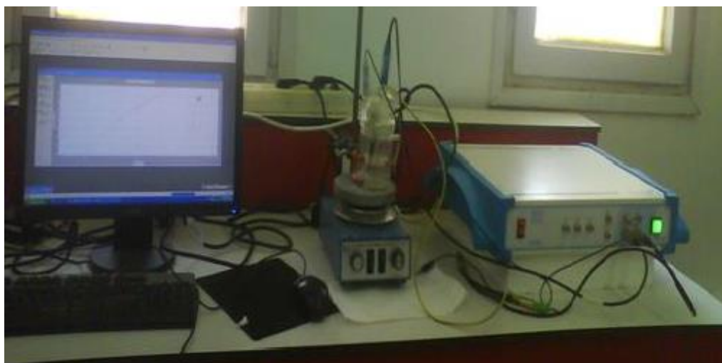
Figure II.15 : Dispositif expérimental utilisé pour les mesures électrochimiques.
