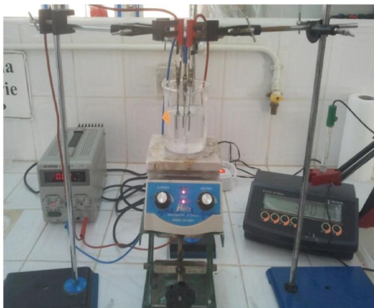
Figure II.6 : Dispositif expérimental de l'électrodéposition de zinc pur.
