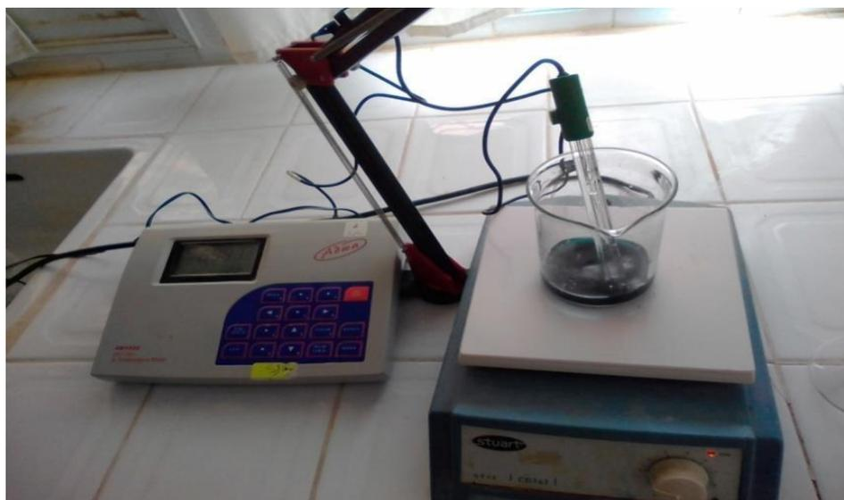
**Figure. 28 :**Protocole de l'adsorption de KEX sur sulfures.
