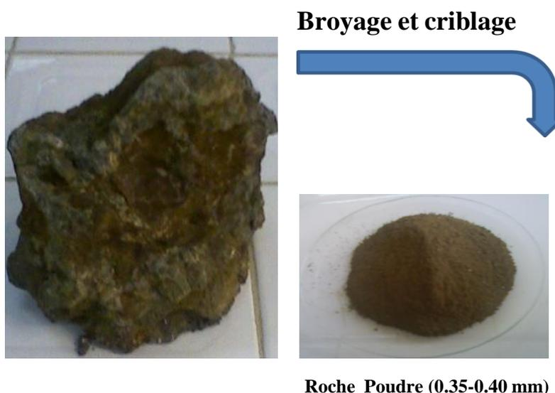
**Figure. 26 :** Protocole de traitement mécanique de la roche.
