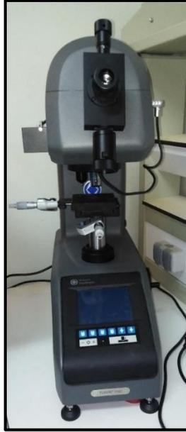
**Figure II.12:** Vickers microhardness testing apparatus ("Laboratoire de Génie énergétique et matériaux (LGEM)", University of Mohamed Khider, Biskra, Algeria)
