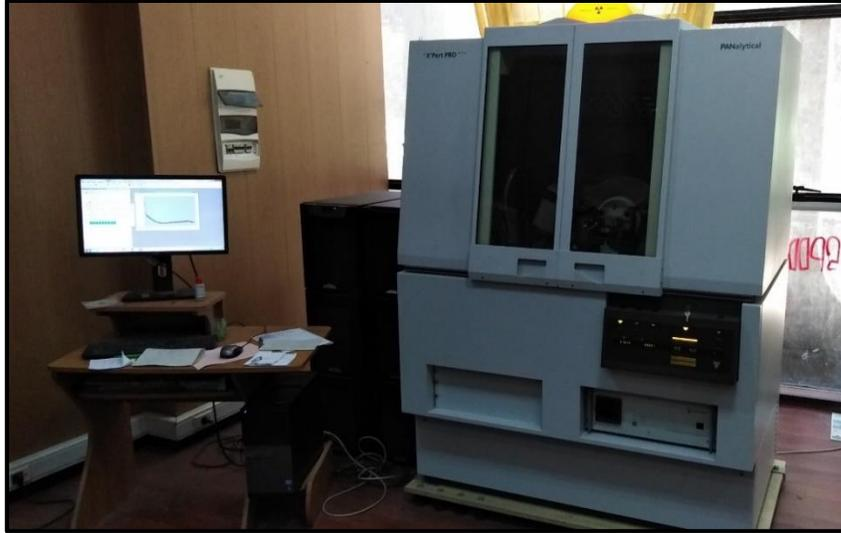
**Figure II.5:** PANalytical X'Pert PRO diffractometer ("Laboratoire des Sciences et de Génie des Matériaux", University Of Science And Technology Houari Boumediene, Algiers, Algeria)
