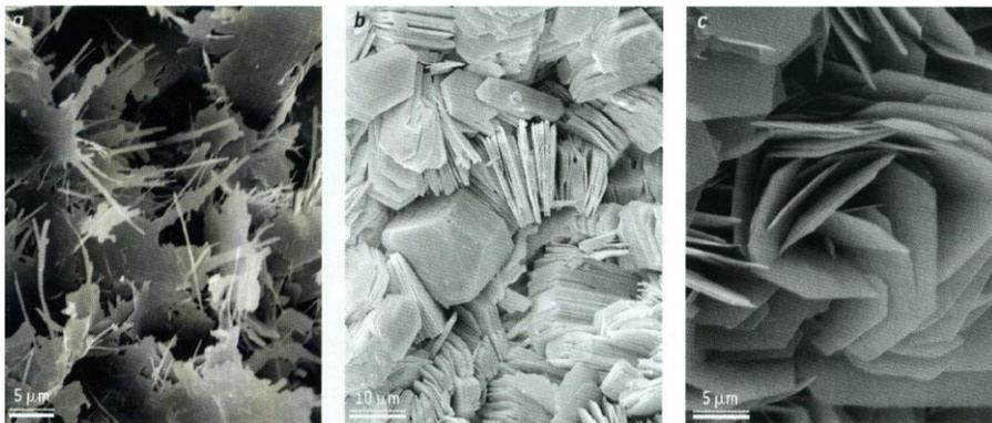
Figure 9. particules d'argiles vues au microscope électronique. source (craterre)
