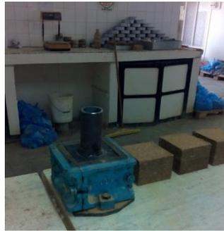
Figure 41 Moule en acier utilisé pour la confection des éprouvettes. Source : Auteur
