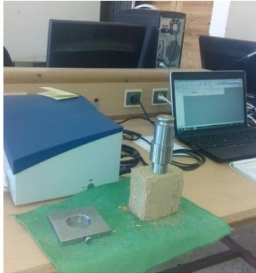
*Figure 50 Dispositif de mesure de la conductivité thermique. Source :Auteur*
