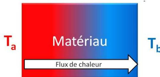
Figure 27 Transfert thermique entre deux surfaces respectivement à la température  $T_a$  et  $T_b$  ( $T_a > T_b$ ).
