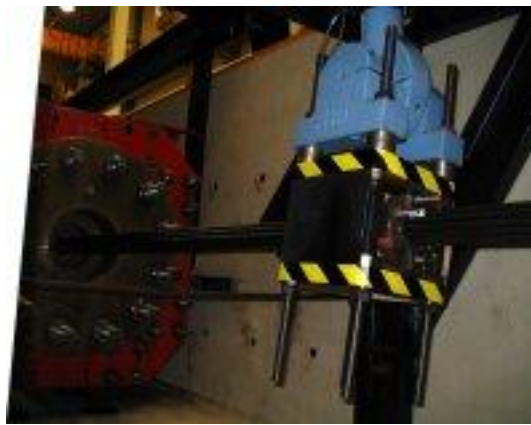
Figure 3.14 : Dispositif LCPC de flexion cyclique associé à l'essai de traction [LCP06].
