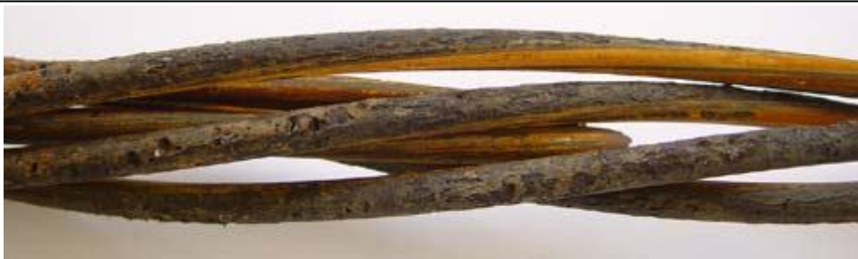
Figure 3.17 : Rupture par corrosion fissurante sous contrainte [BRE05].
