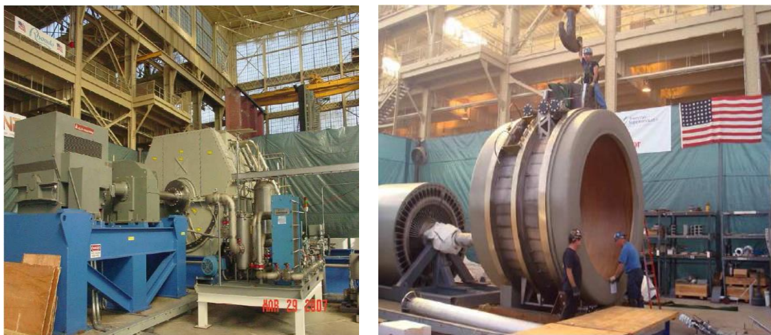
Figure II.3. Moteur 36.5MW réalisé par AMSC (à gauche) stator du moteur 36.5MW (à droite) [www.amsc.com].
