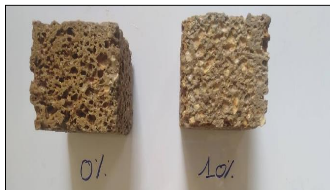
c) Durcissement ultérieur pendant 3 jours après 3 jours de durcissement à la vapeur à 42°C
