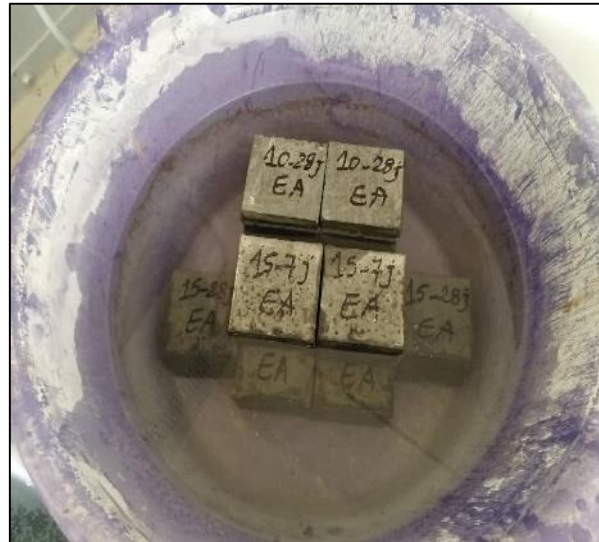
Figure III.8. Image des éprouvettes conservées dans l'eau
