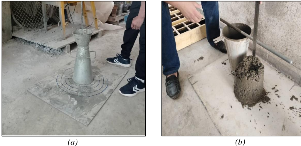
Figure III.7. Images de l'essai d'affaissement au cône d'Abrams : (a) matériels de l'essai, (b) Mesure de l'affaissement
