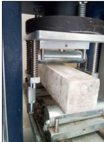
Figure III.13. Dispositif de l'essai de flexion
