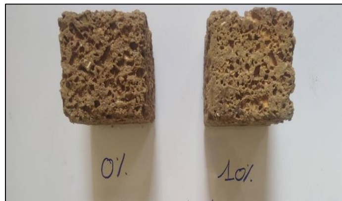
b) Durcissement ultérieur pendant 1 jour après 3 jours de durcissement à la vapeur à 42°C
