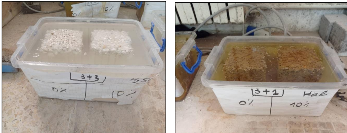
Figure III.15. Conservation des éprouvettes dans les milieux agressifs : 5% H 2 SO 4 et 5%HCl
