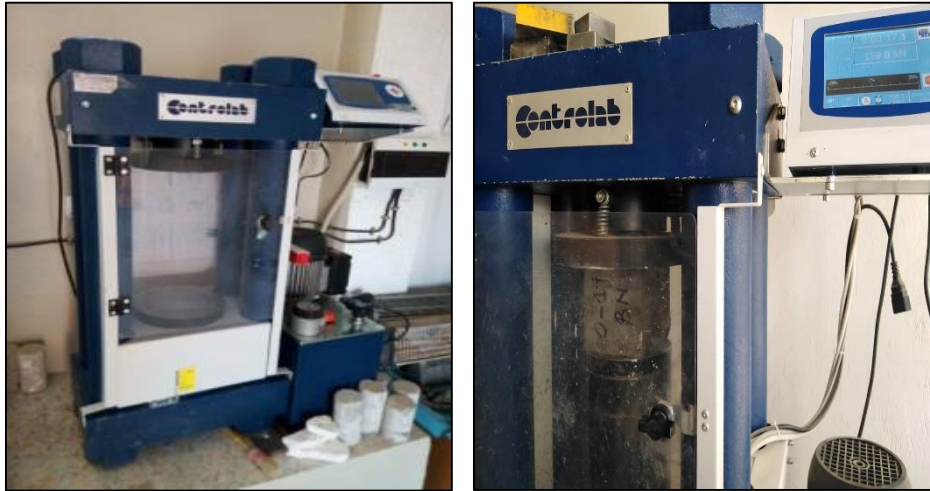
Figure III.12. Machine et dispositif de mesure de la résistance à la compression
