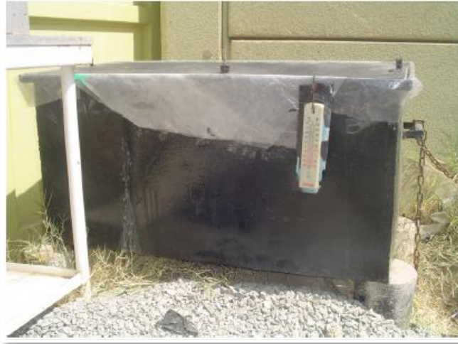
Figure II.33. Chambre de traitement à la vapeur exposée aux rayons solaires utilisée par Benammar et al. [120]
