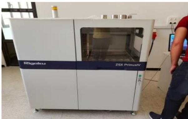
**Figure IV.8.** Spectromètre à fluorescence ZSX Primus IV regaku.
