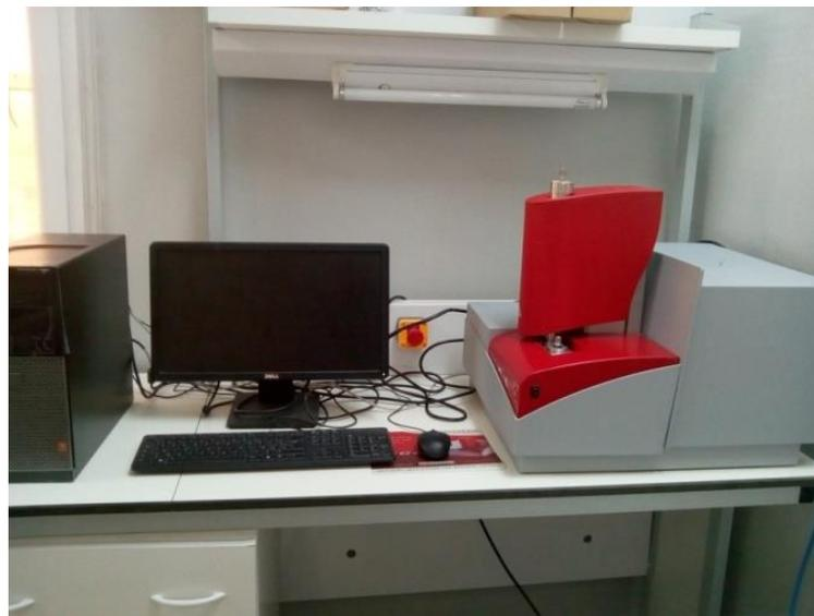
**Figure III. 16** : Analyseur thermogravimétrique couplé (ATG/DSC) de SETARAM Instrumentation LABSYS evo. (Source : Auteur)
