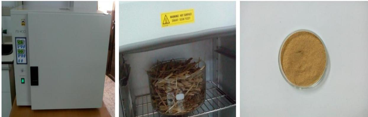
Figure III. 5 : Préparation des fibres de palmier dattier. (Source : Auteur)
