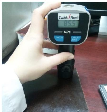
Figure III. 13 : Duromètre Shore A de type Zwick/Roell. (Source : Auteur)
