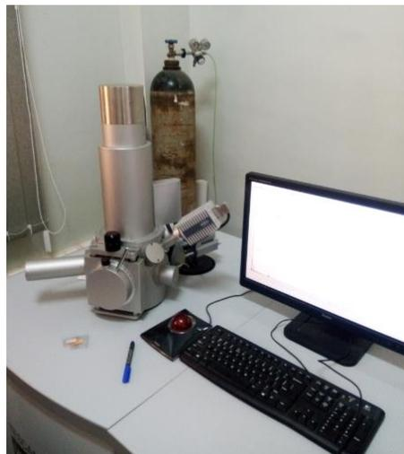
**Figure III. 14** : Microscope électronique à balayage (MEB/EDX) de type TESCAN VEGA3.
