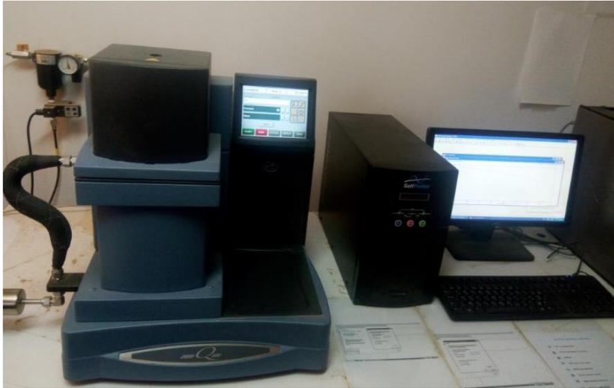
**Figure III. 18 :** Instrument d'analyse mécanique dynamique DMA type TA, Q800. (Source : Auteur)
