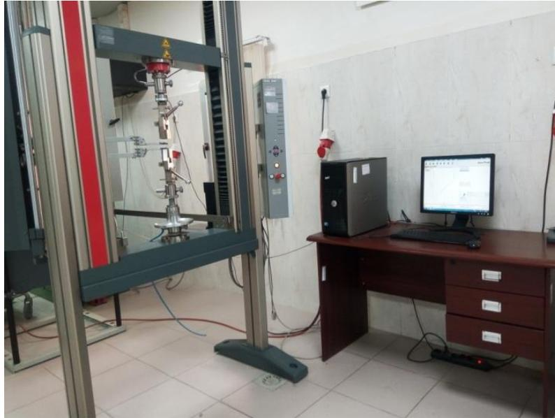
Figure III. 12 : Machine de traction de type Zwick/Roell Z050. (Source : Auteur)
