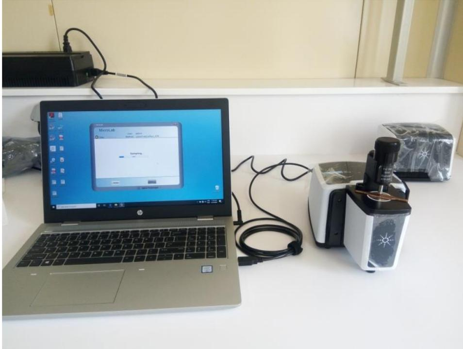
**Figure III. 11** : Spectromètre Agilent Cary 630 FTIR. (Source : Auteur)
