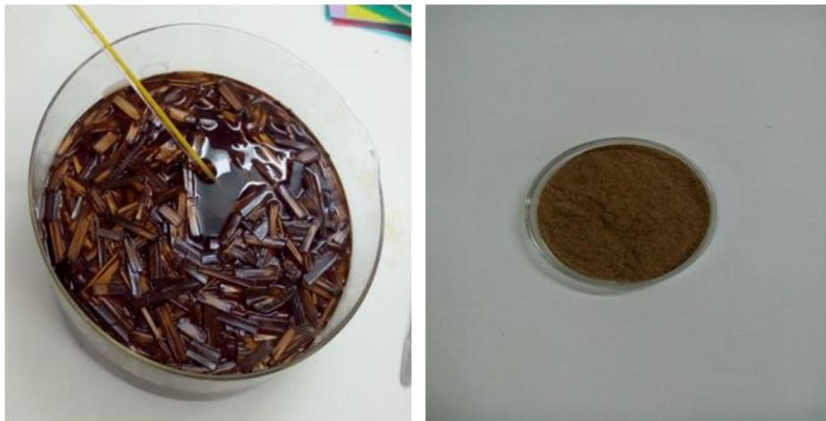
**Figure III. 7:** Préparation des fibres de palmier dattier DPLF traitées avec une solution de NaOH de 6%. (Source : Auteur)
