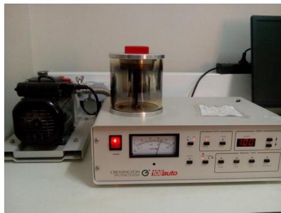
**Figure III. 15** : Métalliseur de type Cressington Sputter Coater 108 auto. (Source : Auteur)
