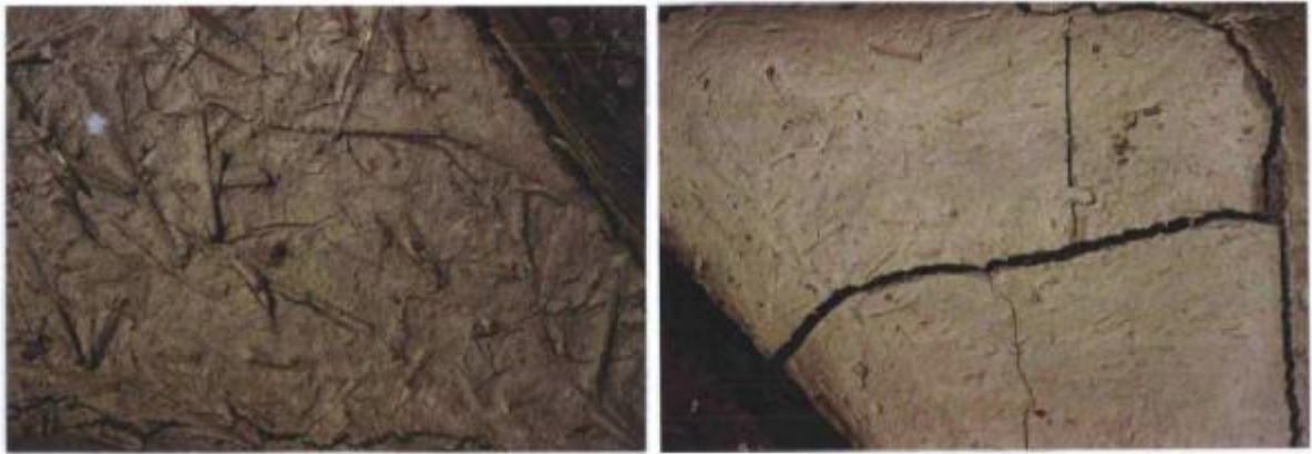
Figure I-10 La surface de la bauge renforcée par les fibres et sans fibre à l'état sec (Addison Greer, 1996)
