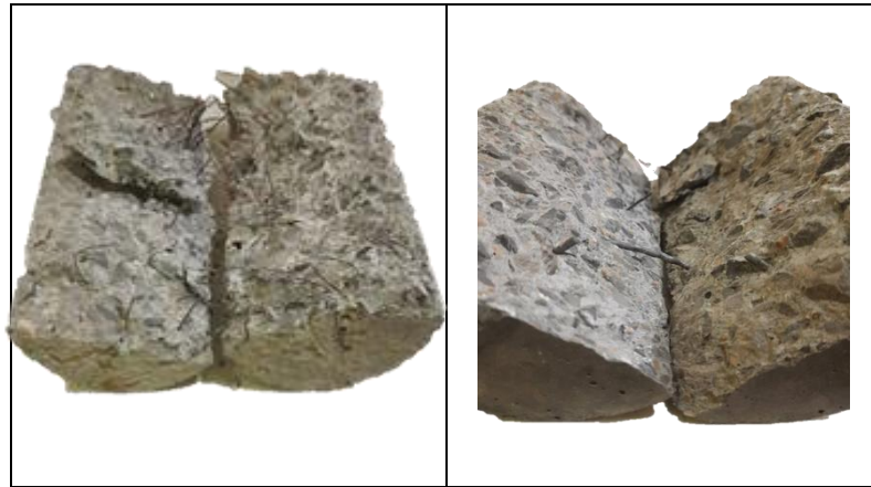
Figure IV-13 Modes de rupture des éprouvettes à la traction par fendage
