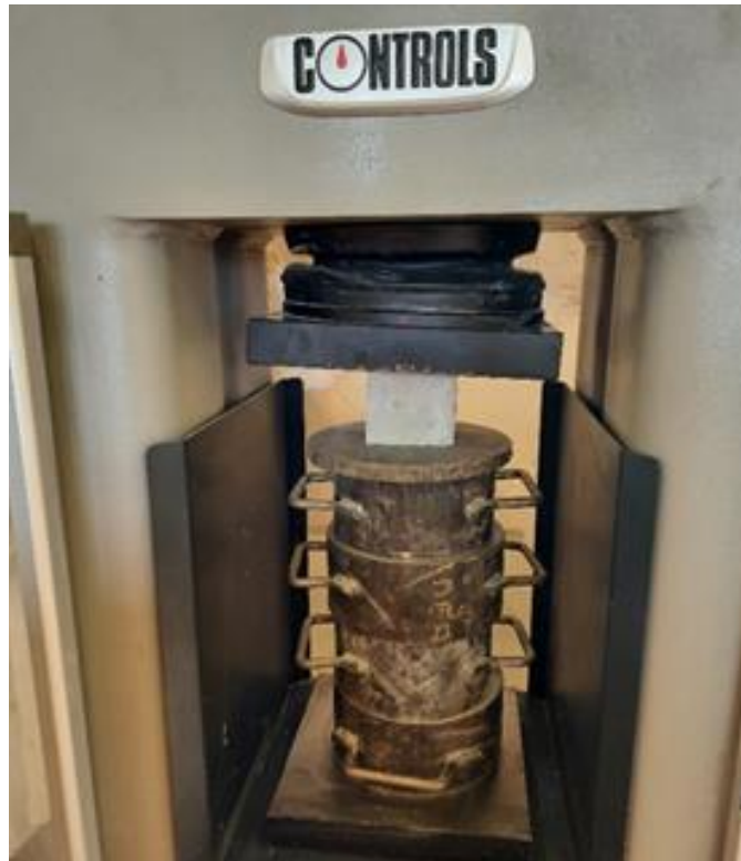
Figure II-9 Mise en place des éprouvettes sur presse hydraulique (La résistance en compression).
