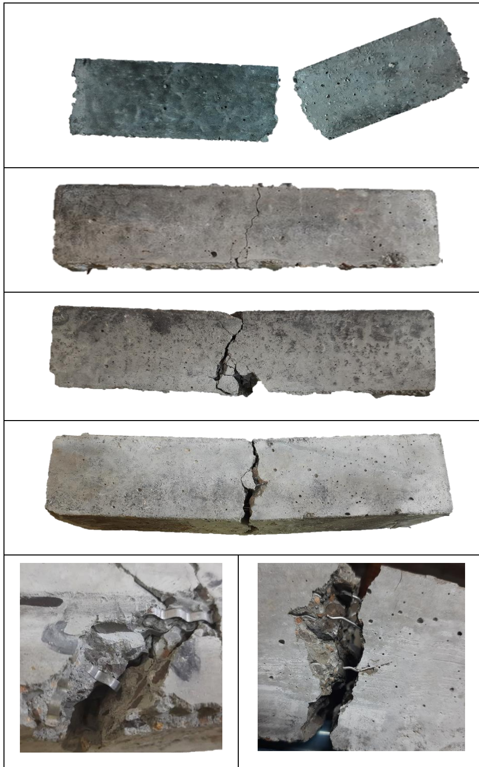
Figure IV-21 Modes de rupture des éprouvettes en flexion
