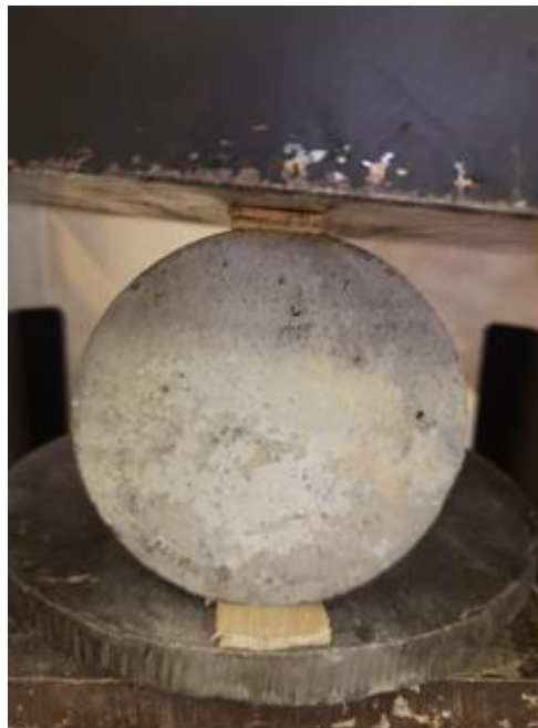
Figure II-10 Mise en place des éprouvettes sur presse hydraulique (Essai de traction par fendage).
