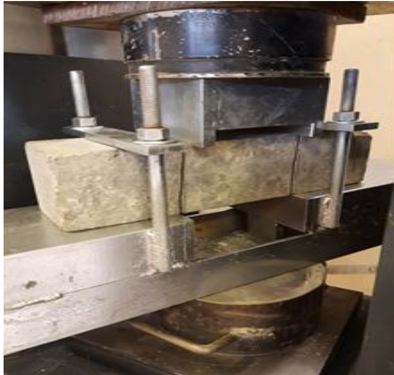
Figure II-14 Montage de cisaillement, JSCE-SF6
