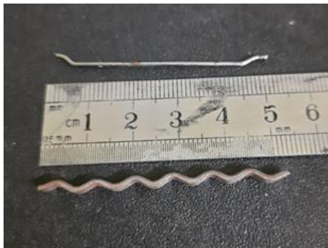
Figure II- 6 Les deux fibres d'acier utilisées
