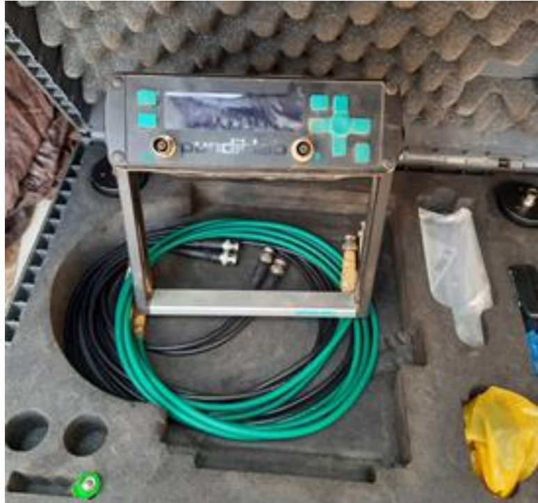
Figure II-8 L'essai de vitesse de propagation d'ondes sonores
