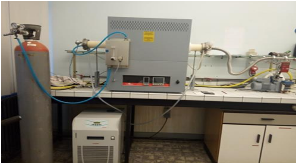
Figure 3. 5: Four utilisé pour le soudage par diffusion.
