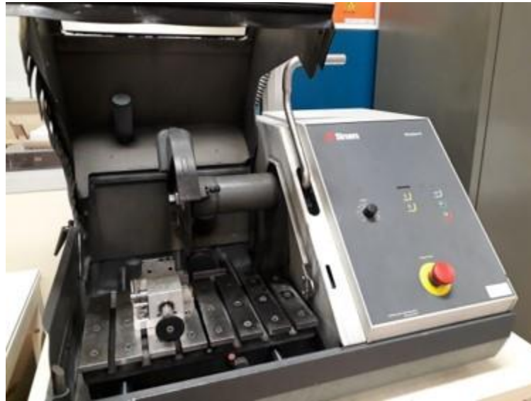
Figure 3. 2: Tronçonneuse sous lubrification
