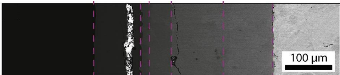
Figure 2. 17: Micrographie BSE montrant les phases obtenues après le recuit à 500°C pendant 312 heures [41].
