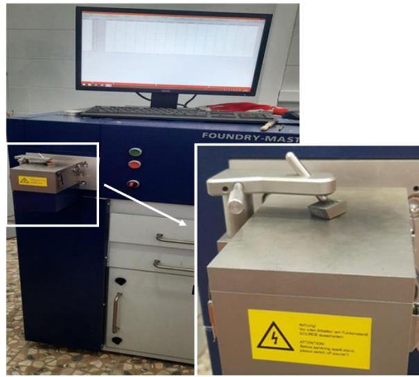
Figure 3. 1: Spectromètre à étincelage.
