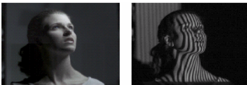
Figure 21 : Lumière structurée illuminant un visage.
