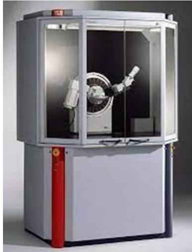
Figure II.10 : Diffractomètre à rayons X de type Bruker D8 ADVANCE,
