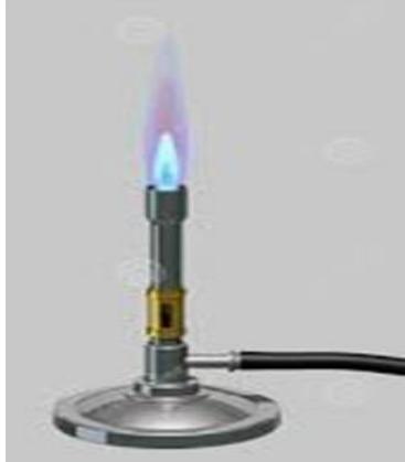
Figure II.3 :Bec du gaz à  $\sim 850^\circ\text{C}$
