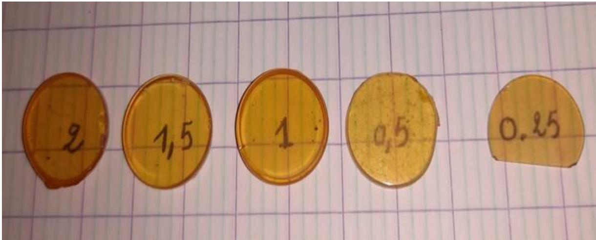
Figure III.1: Photographie des échantillons de verre dans le système SWLi(x) BiEr0.25
