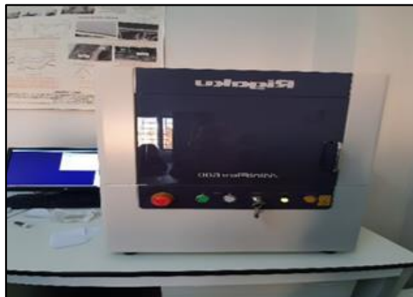
Figure I.15 Appareil utilisée pour la mesure DRX des adsorbants utilisés (Rigaku-MINIFLEX-600) (Laboratoire de recherche LPCMA –Université de Biskra)
