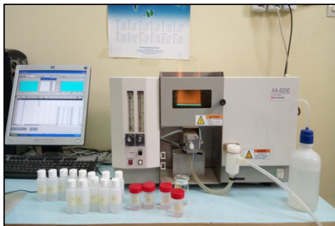
Figure I.10 Dosage du cuivre dans les échantillons prélevés par utilisation du Spectrophotomètre à absorption atomique-Schimadzu AA-6200 (Laboratoire pédagogique du Département d'Agronomie-Université de Biskra)
