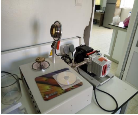
Étape 1: Métallisation de l'adsorbant
