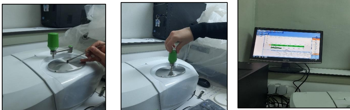
Figure I.16 Technique de la détermination du spectre ATR-FTIR par utilisation du Perkin elmer spectrum two (Laboratoire de recherche LPPNM –Univ-Biskra)
