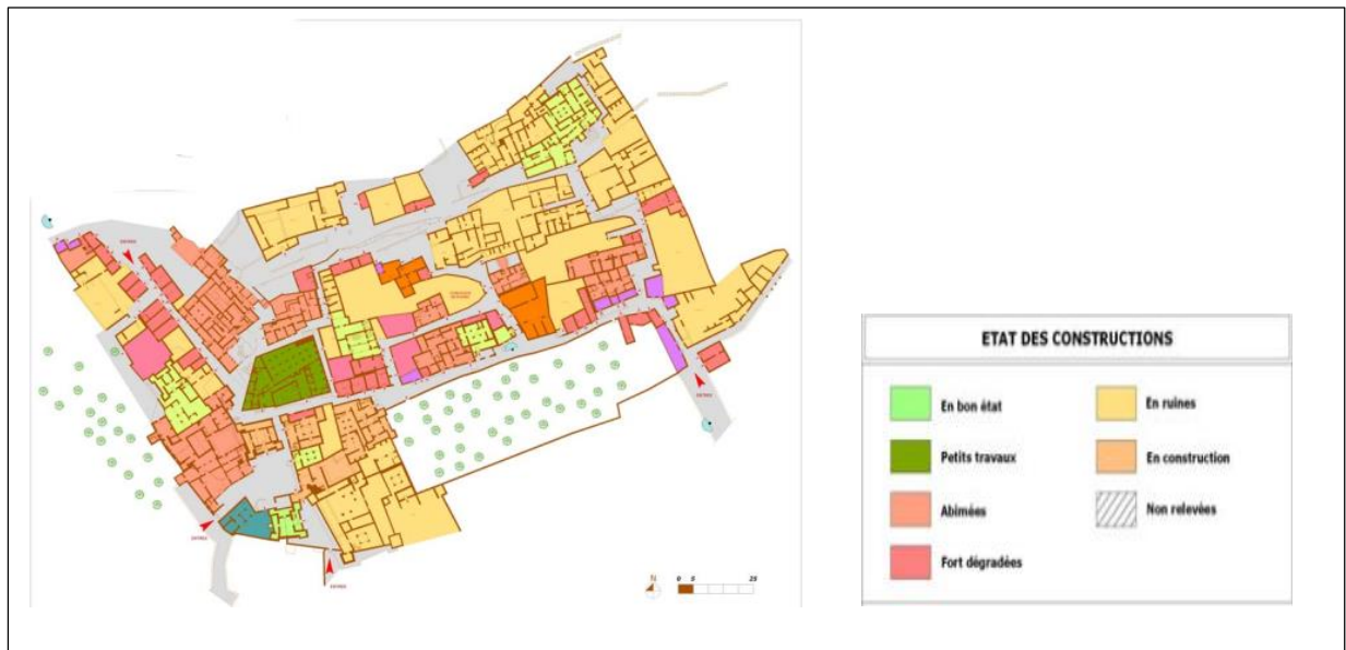
Fig. n° 59 : Carte montrant l'état de conservation du ksar Ait Ben Haddou.
