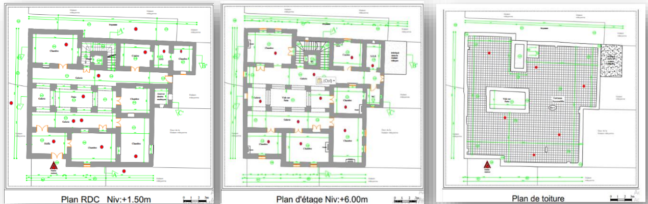
Fig. n°133 : Localisation des désordres (humides et structurels) sur les différents niveaux de la maison Ben Hassine. Plans établi d'après le relevé. Source : Auteure. 2022.
