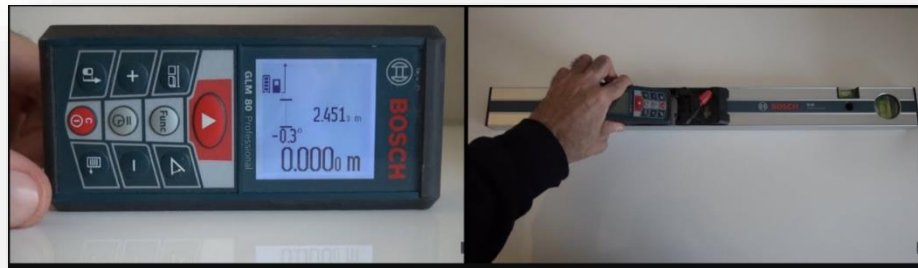
Photo n°103 : Disto Meter appareil de mesures de distances. Source : Auteure.2022.
