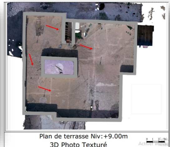
Fig. n°134 : Dégradation du carrelage de la terrasse et apparition de fissures sur le plancher. Source : Aueture.2022.
