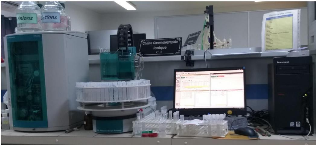
**Figure 27** : photo de Chromatographe ionique (850 Professional IC Metrohm)
