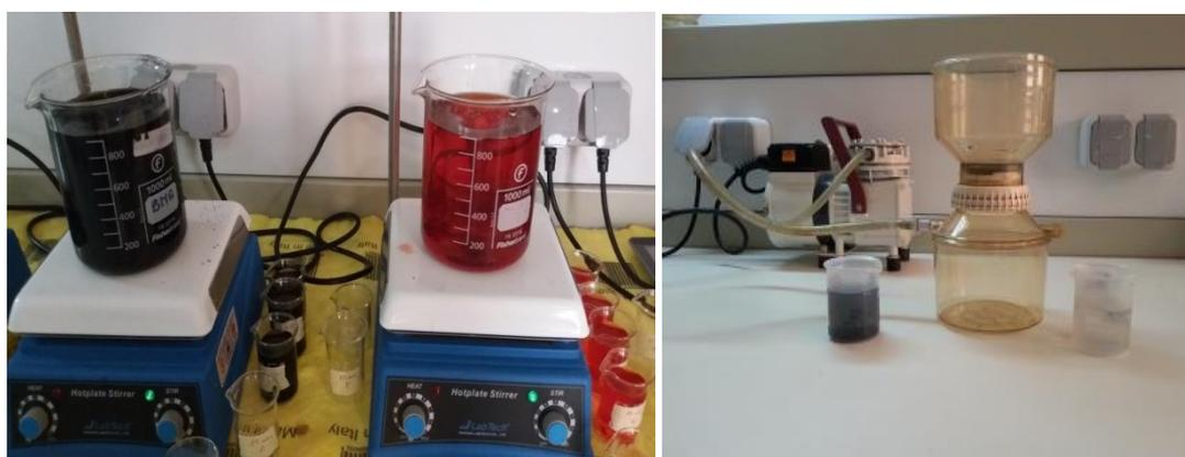
**Figure 30** : Photos de Cinétique d'adsorption du RC sur le CAP et le CAG et la Pompe de filtration sous vide
