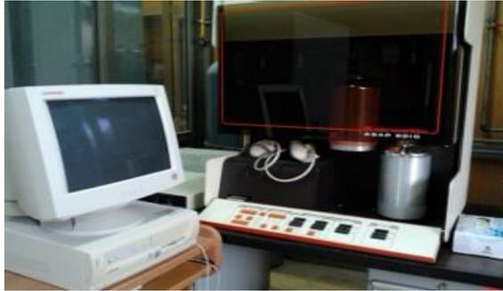
**Figure 18** : Photo d'Équipement ASAP 2010 V5.00
