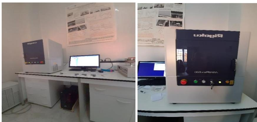
**Figure 15:** Photo de l'Appareil utilisée pour la mesure DRX des adsorbants utilisés (Rigaku-MINIFLEX-600) (Laboratoire de recherche LPCMA –Univ-Biskra)
