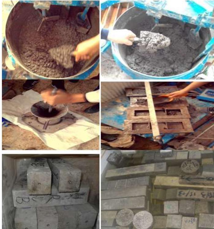
**Figure II. 10:** Les différentes étapes de formulation, façonnage, affaissement et conservation.
