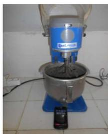
**Figure II.7 :** Malaxeur à mortier
