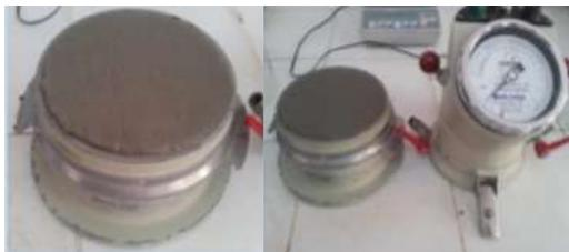
**Figure II.16 : Aéromètre à mortier**
