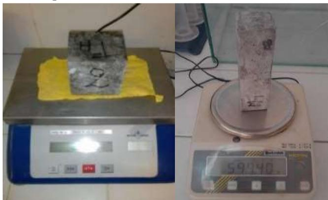
**Figure II.17** : Mesure de la masse volumique des composites.
