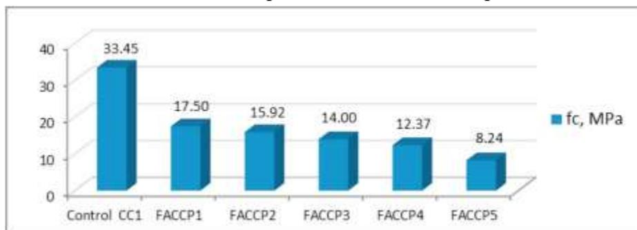
Figure I.26 : Variation de la résistance à la compression du béton avec du polystyrène et le cendre volante (Costin et al., 2018).
