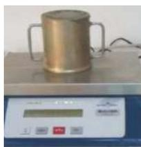
Figure II.15 : Mesure de la masse volumique à l'état frais.
