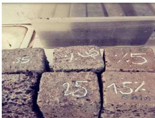
**Figure II. 24 :** Éprouvettes immergées dans la solution de l'acide chlorhydrique (HCl).
