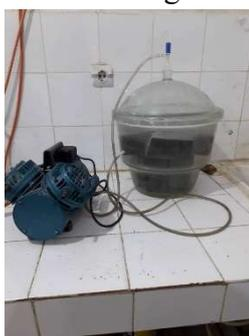
Figure II. 22: Dispositifs utilisés pour l'essai d'accessibilité à l'eau
