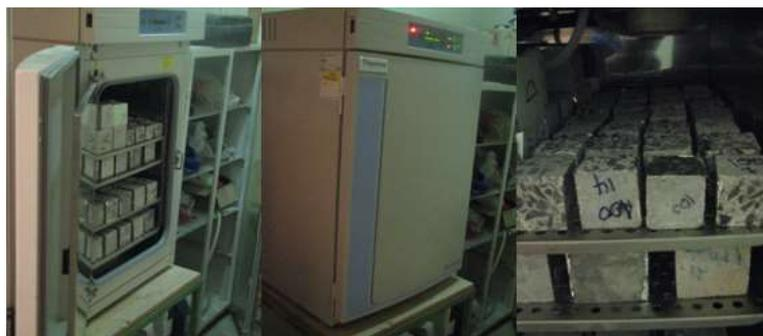
**Figure. II.25 :** Enceinte hermétique (c+hambre de CO<sub>2</sub>).
