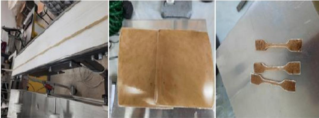
Fig. II.6 : Préparation d'éprouvette en polypropylène avec la charge traité et/ou non traité.
