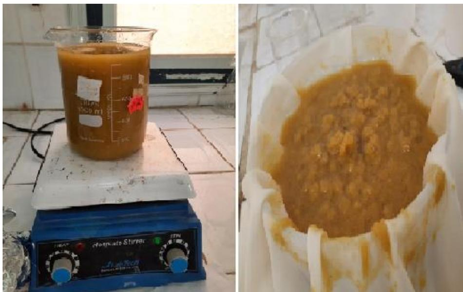
Fig. II.2 : fibre Alfa non traité sous agitation pendant 1h puis filtration
