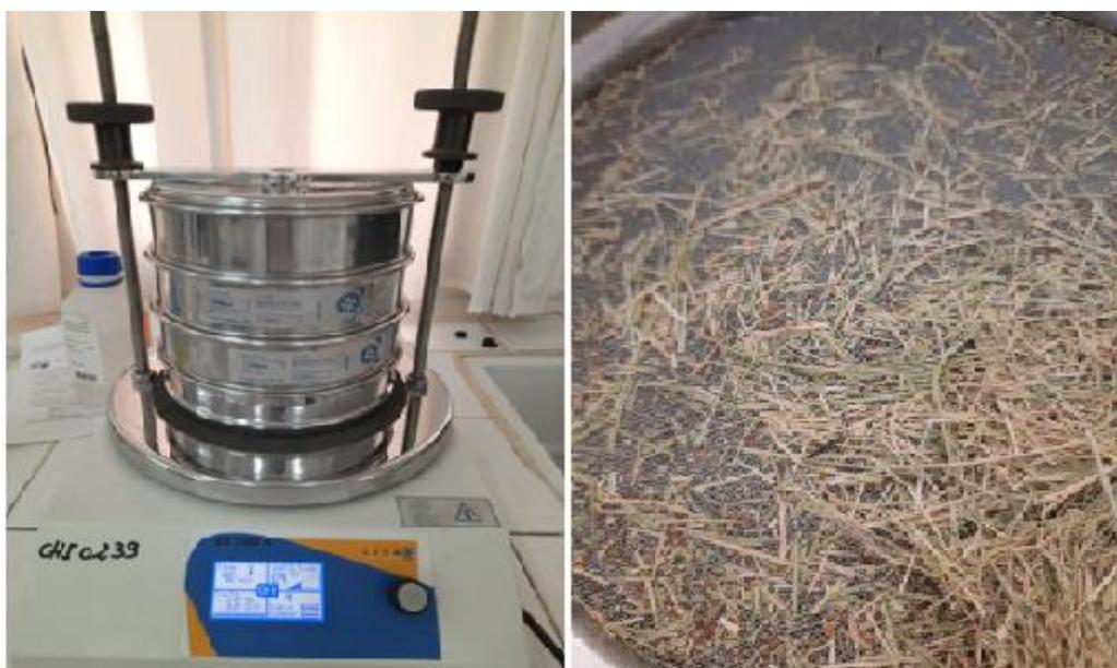
Fig. II.1 : Fibre Alfa tamisé en 180µm de diamètre
