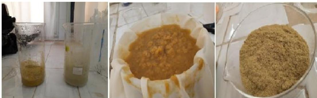
Fig. II.3 : Fibre Alfa traité avec la soude caustique et l'acide sulfurique
