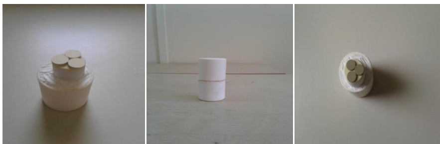
Figure II.6. Pastilles avant et après frittage
