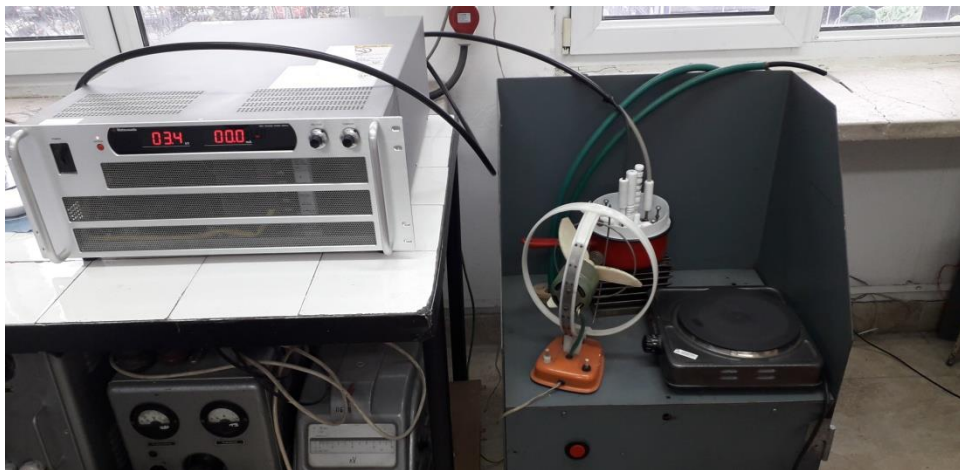
Figure II.17. Photo du dispositif expérimental pour la polarisation des céramiques
