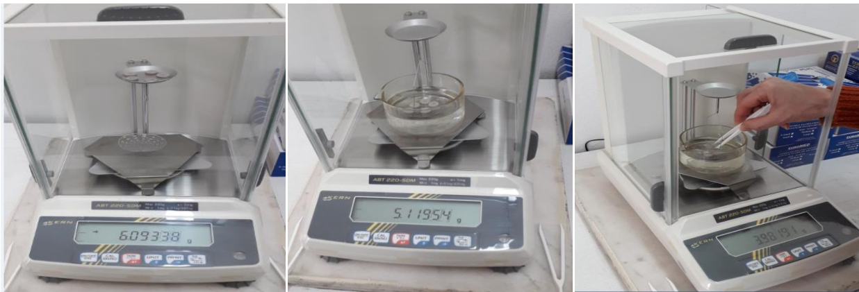
Figure II.23. pesée des échantillons sous air et dans l'eau au moyen d'une balance (KERN)
