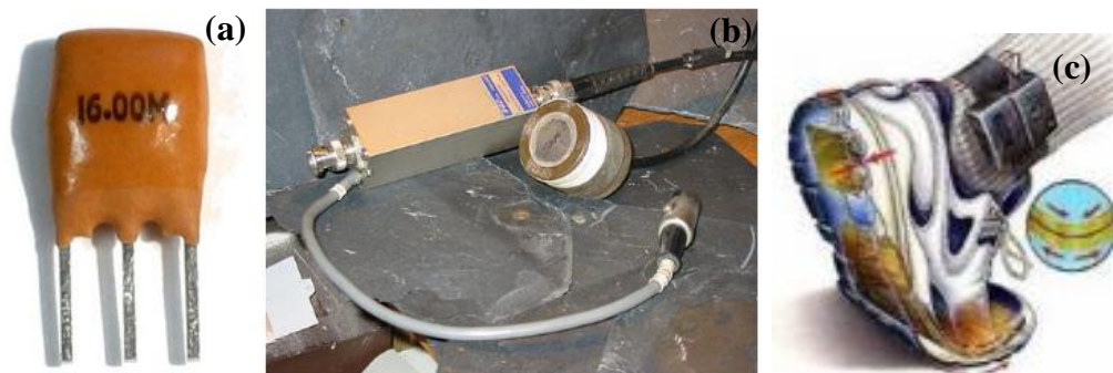
Figure I.8. Dispositifs en céramique PZT intégrés dans des applications industrielles. (a) Résonateur céramique, (b) Transducteur à ultrasons, (c) Récupération de l'énergie humaine.
