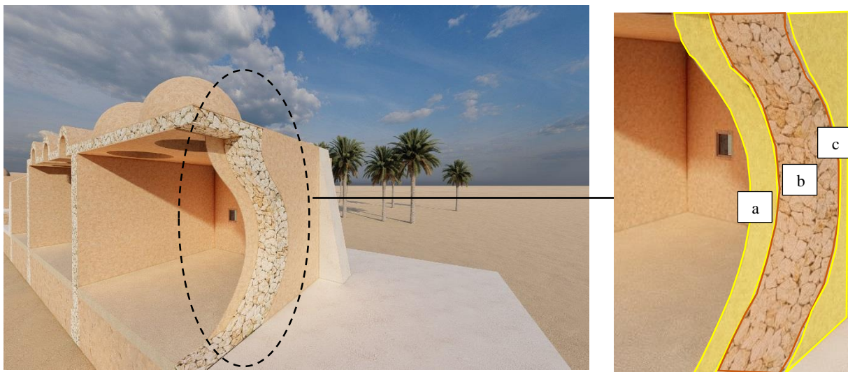
Figure IV.20 : Coupe 3D des composants d'un mur de la maison traditionnelle d'El Oued (source : auteurs)
