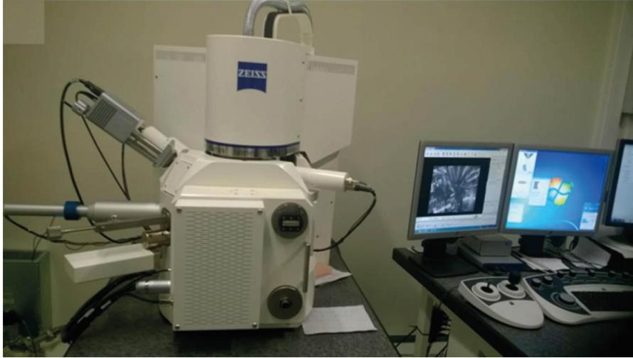
**Figure II.3** Le microscope électronique à balayage équipé du système d'analyse EBSD (SP2M/ICMMO, Université Paris-Saclay, France).
