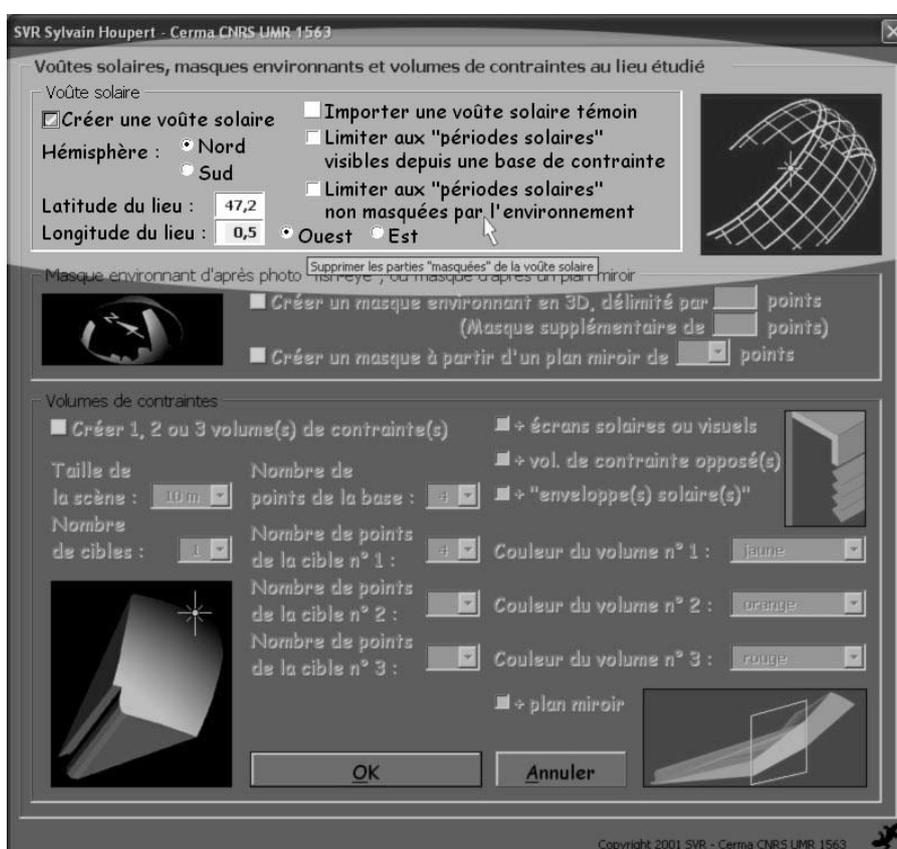
Figure 94 : Interface du prototype de logiciel Réflexions solaires et visuelles (SVR) (Houpert, 2003)
