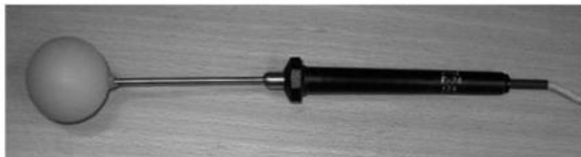
**Figure IV. 23 :** Thermomètre 38 mm plat globe gris. (Source: Thorsson et al., 2007)
