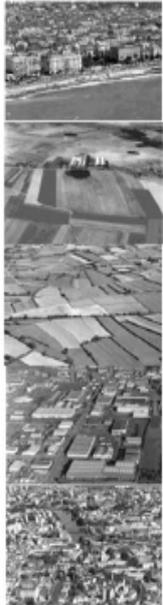
**Figure I. 14** : Les cinq catégories de rugosité. (Source : L'annexe nationale de l'eurocode EN 1991-1-4)
