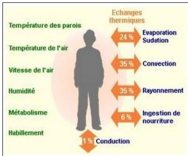
**Figure II. 1 :** Les différents paramètres influençant sur le confort thermique en générale.
